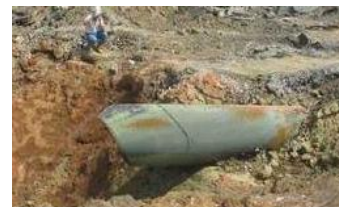
Figuur 3.7: Volledige afschuiving
