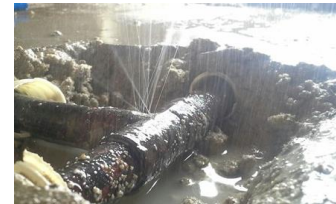
Figuur 3.9: Falen koppeling
