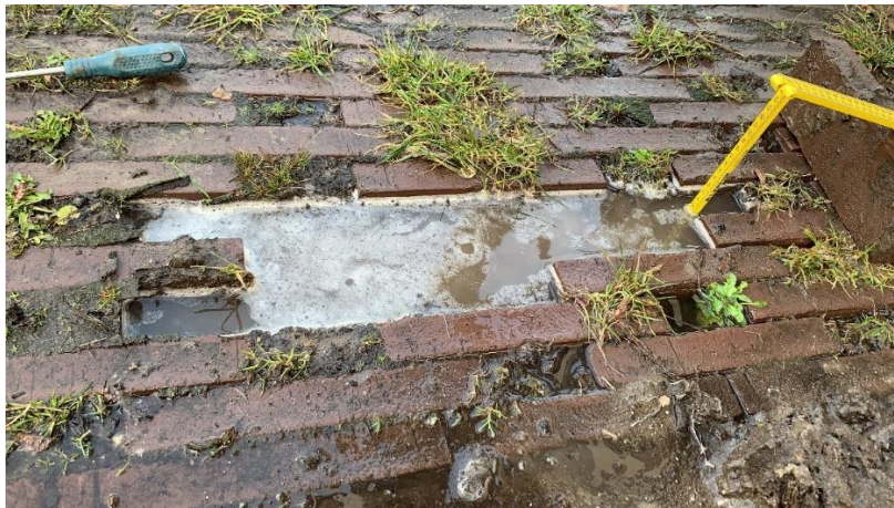
Figuur 2-4 Ankeveenstraat vlijlaag doorlatendheid
