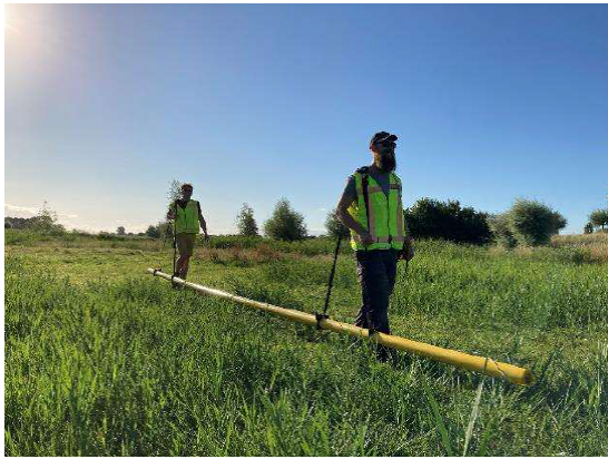
Figuur 9. De veel gebruikte methode of EM-metingen te verzamelen is met behulp van een lange buis die een magnetisch veld creëert die tientallen meters diep de grond inreikt. De rauwe data output bestaat uit profielen die de elektrische weerstand in de ondergrond weergeven.
