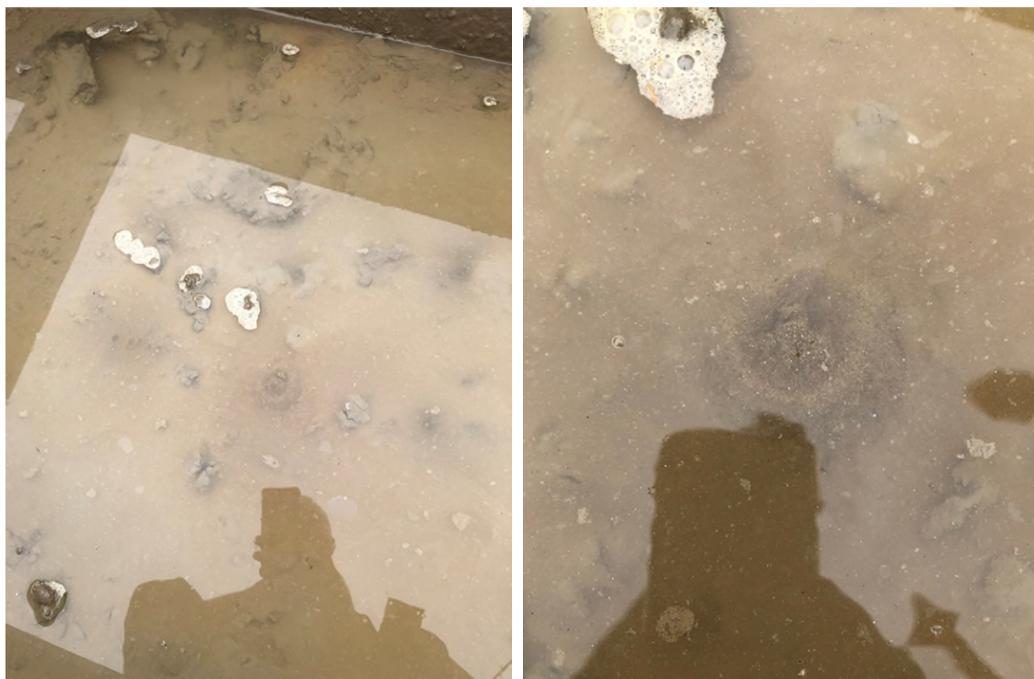
Figuur 3: Kleine zandmeevoerende welletjes in proefvak zuid tijdens bijvullen van 1 van de buizen tijdens de testweek van de systemen
