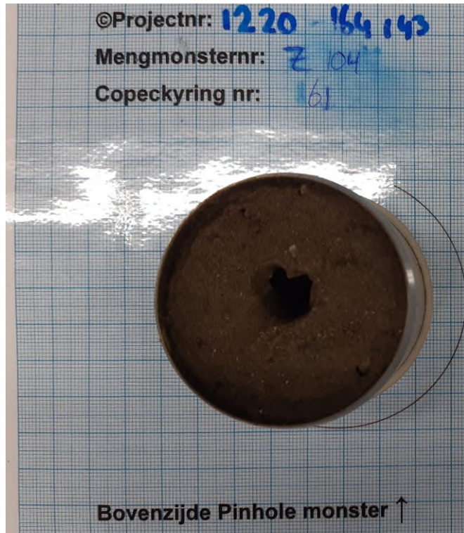
Figuur 7.3: Monster Z104 na uitvoering van de Pinhole Test. Dit monster is aan de bovenzijde nog intact, waar duidelijk de uitspoeling in het midden van het monster zichtbaar is.
