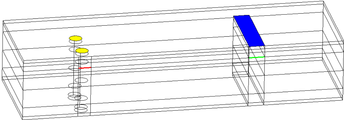
Figuur 2-3 Geometrie en randvoorwaarden met constante stijghoogte in het model voor de pipingberekeningen met het Sellmeijer model
