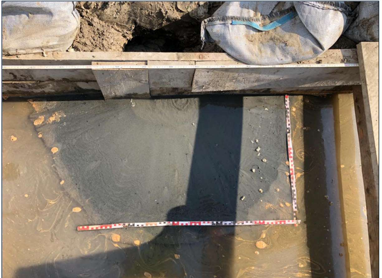
Figuur 2.6: Zandmeevoerende wel waarbij tijdens de proef zand is afgeschept (monsters: N1-N42).
