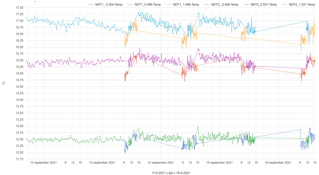
Figuur 26 – Temperatuurtrend op verschillende dieptes t.h.v NDT1 en NDT2
