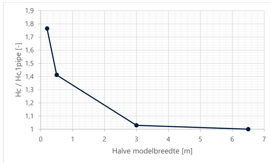
Figuur 4-2: Effect van toestroomgebied naar de pipe op het kritiek verval: bij een halve modelbreedte van 6,5 m is het model volledig 3D, een halve modelbreedte van 0,2 m simuleert een pipe patroon met pipes op afstand van 0,40 m van elkaar.
