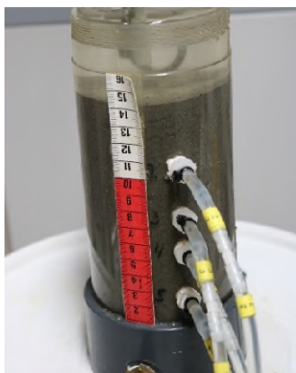
Figuur 2-7: Gebruikte opstelling van de doorstroomproef voor het meten van de doorlatendheid.
