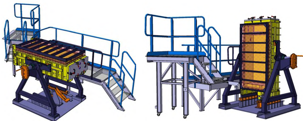
Figuur 2-4: Medium schaalopstelling. Links: in horizontale positie, zoals tijdens de proef. Rechts: verticale positie voor tijdens het vullen.
