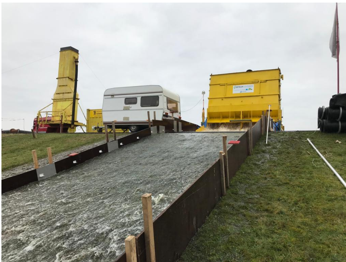
Figuur 4-8: Overslagsimulatoren bij het onderzoeksproject Gras op Zand
