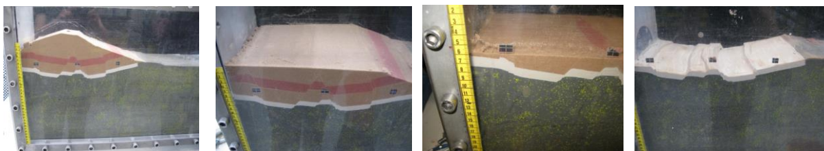
Figuur 4-4, Voorbeeld onderzoek; Stapsgewijs verwijderen dijklchaam en het vastleggen van het bezwijkmechanisme in het dijklchaam
