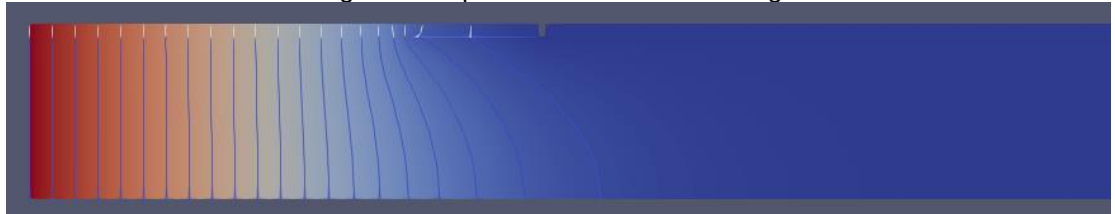
Figuur 8.5 Stijghoogte contouren in model met 39 m ondoorlatend voorland, gelijk aan de fictieve voorlandlengte, en horizontale instroom door verticale rand. Model 25 m dik.
