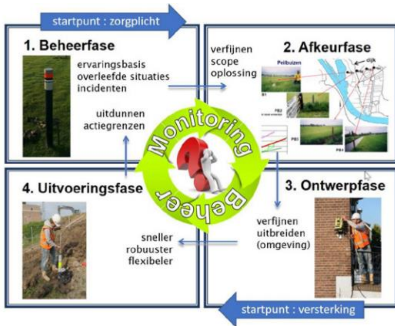
Figuur 3-4 Lifecyclemonitoring waarin de kering in een samenspel van beheer, afkeur, ontwerp en uitvoering op orde wordt gehouden [15]
