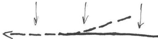
Figuur 102 Schuine insteek en overlap bij herstart met kettinggraafmethode (mogelijke principe-oplossing).
