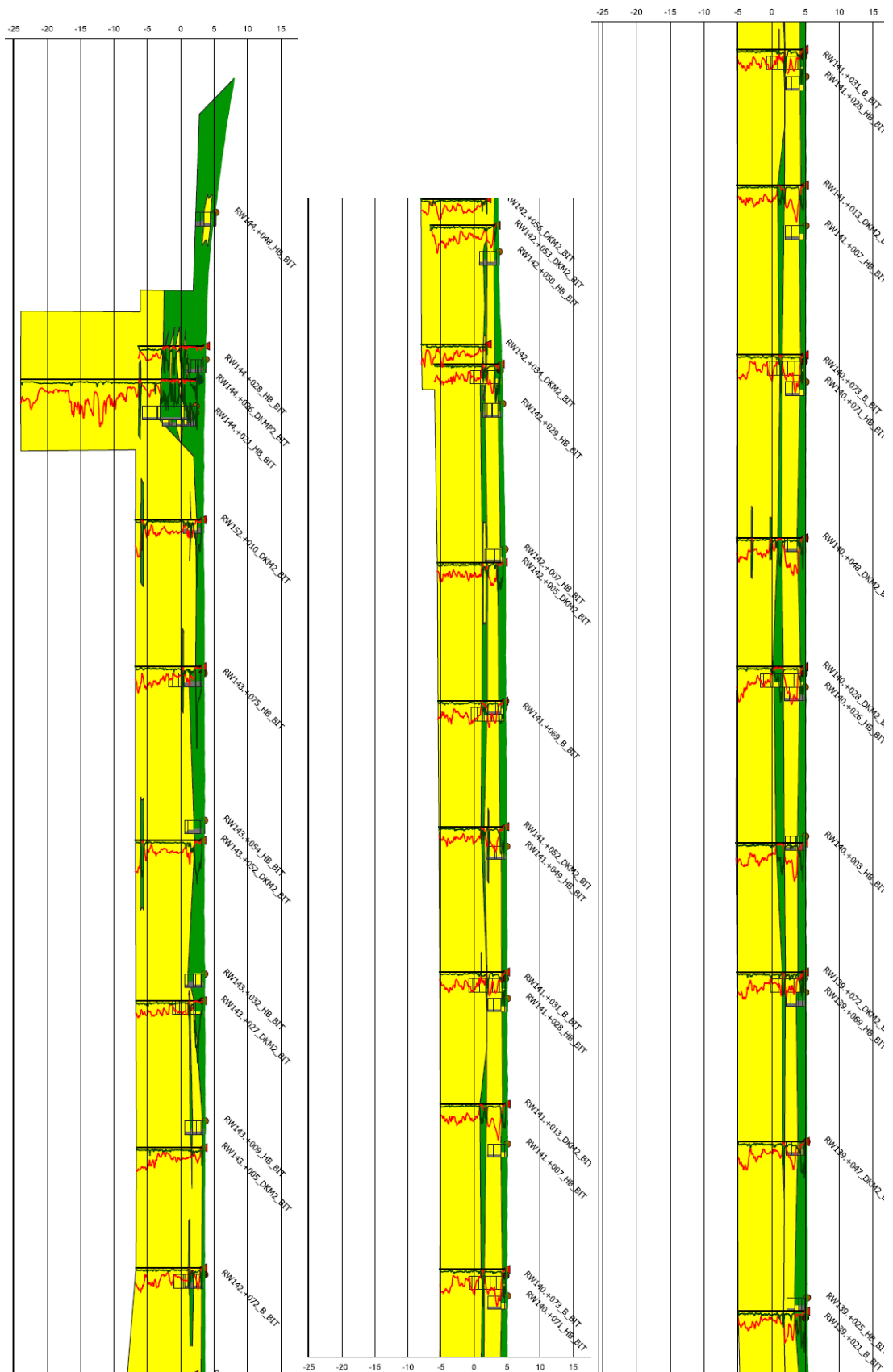
Figuur 453 Lengteprofiel met sonderingen en onderscheid naar klei- en zandlagen (resp. groen en geel), van RW145+000 tot RW142+058, van RW142+058 tot RW140+050 en van RW140+050 tot RW139+015 (Geurtjens, 2021).
