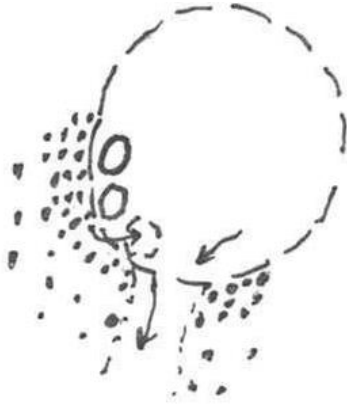
Figuur 105 Contacterosie leidend tot pipevorming langs de omtrek van een grondverdringend aangebrachte zandpaal als grofzandbarrière.
