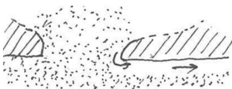
Figuur 135 Onderbroken deklaag – pipe groeit niet verder, maar voert bovenliggend materiaal af.
