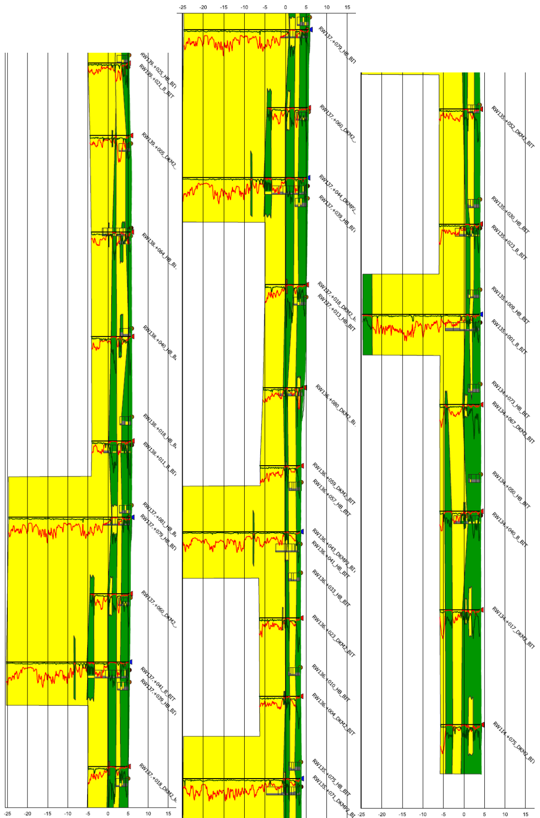
Figuur 454 Lengteprofiel met sonderingen en onderscheid naar klei- en zandlagen (resp. groen en geel), van RW139+027 tot RW137+000, van RW137+082 tot RW135+062 en van RW135+062 tot RW133+065 (Geurtjens, 2021).
