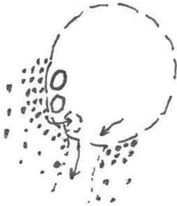
Figuur 283 Contacterosie leidend tot pipevorming langs de omtrek van een grondverdringend aangebrachte zandpaal als grofzandbarrière.
