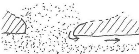
Figuur 34 Onderbroken deklaag – pipe groeit niet verder, maar voert bovenliggend (granulair) materiaal af.
