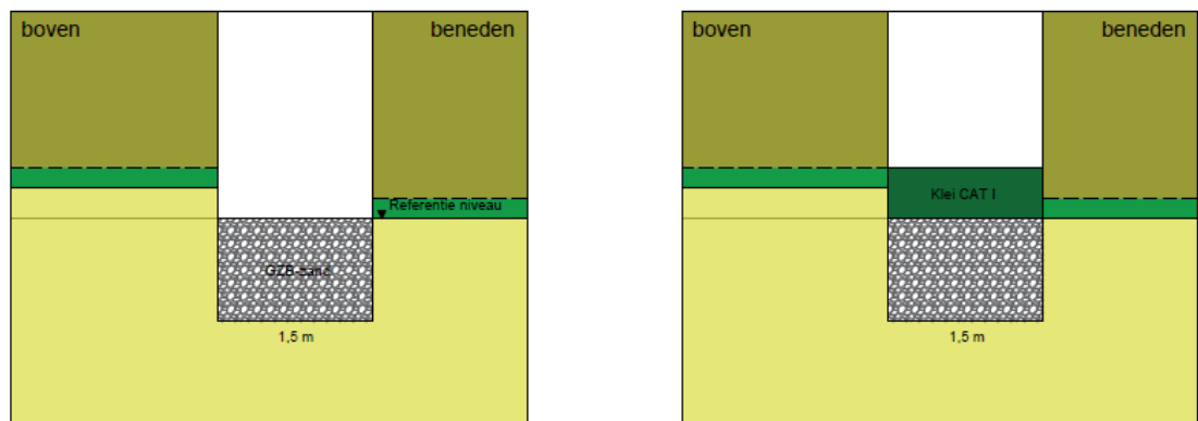
Figuur 459 Aanleg Definitief Ontwerp, fase 1 (links, onderste 1,5 meter gevuld met grof zand) en fase 2 (rechts, inkassing geheel gevuld met klei) (Boone, 2021b).
