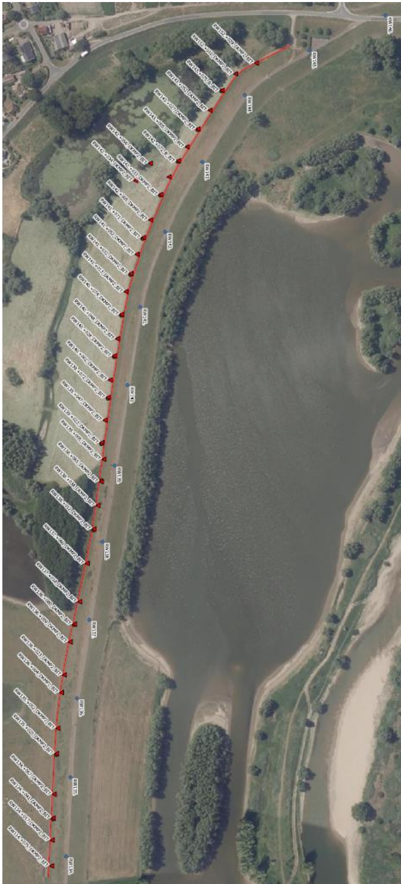
Figuur 452 Bovenaanzicht met indicatie van dijkpalen, tracé grofzandbarrière (doorgetrokken rode lijn) en uitgevoerde sonderingen nabij en in het tracé van de grofzandbarrière (rode driehoeken), met het noorden naar rechts (Geurtjens, 2021).
