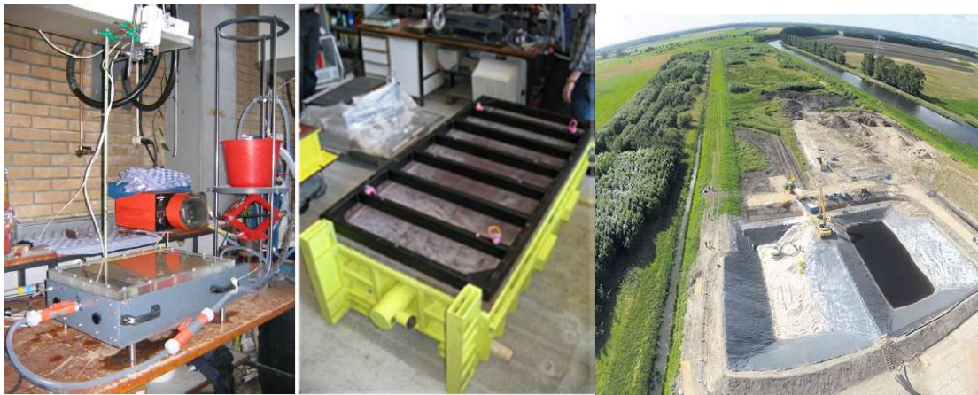
Figuur 2-6. Pipingproeven, van links naar rechts: small scale, medium scale en de IJkdijk.
