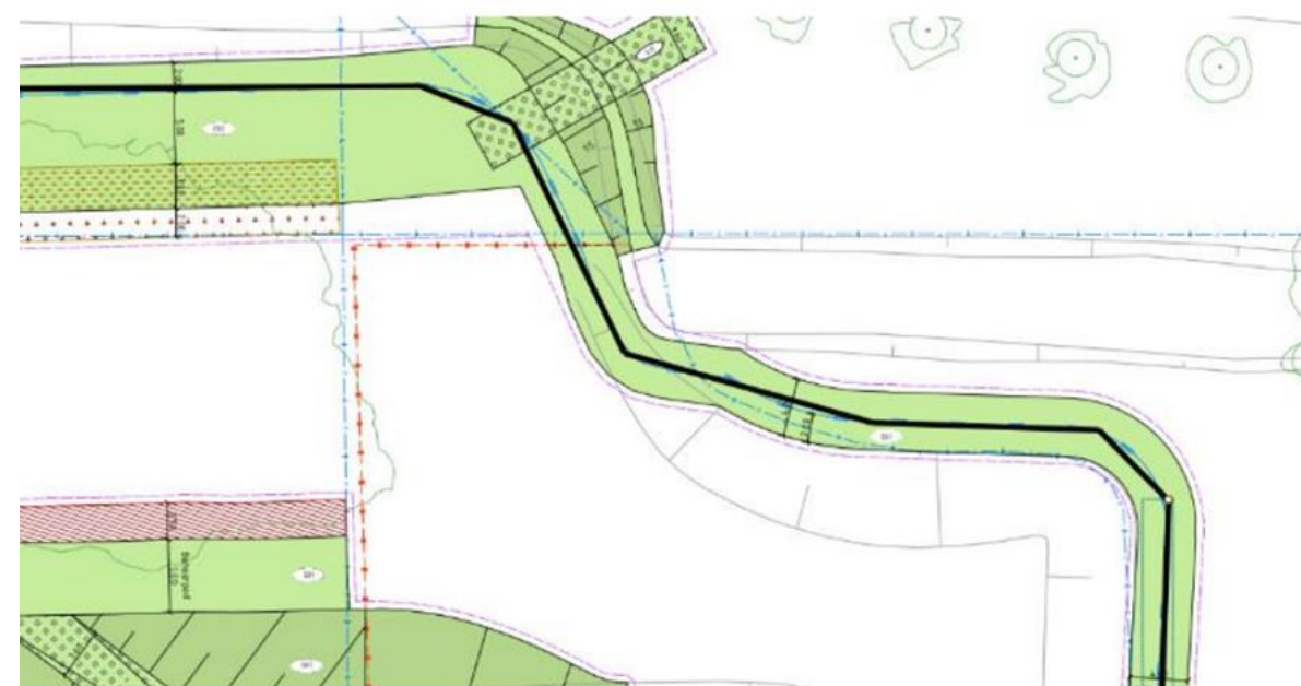
Figuur 3.13 Bochten in het grofzandbarrièretracé bij Dijkversterking Stad Tiel (het noorden is naar rechts in dit bovenaanzicht).
