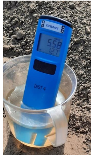
2. Zet de Hanna Dist4 EC-meter aan en zet hem in de beker
