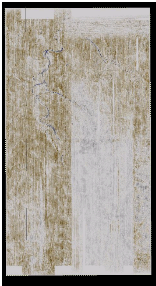
Fig. 17 Detailopname van een 3D seismiekvak. De afmetingen zijn ongeveer ~ 25 km bij ~ 50 km. Geïnterpreteerd in blauw zijn meanderende geulafzettingen met daarlangs vage oeverwalafzettingen. Deze afzettingen zullen een contrast in lithologie laten zien, waarbij de geulafzettingen over het algemeen grover van aard zijn dan de oeverwalafzettingen.
