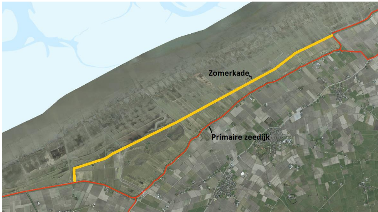
Figuur 3-4 Zomerkades (geel) op de kwelders van Noord-Friesland Buitendijks voor de primaire kering (rood). Bron: Van der Reijden (2019) / Geoweb.
