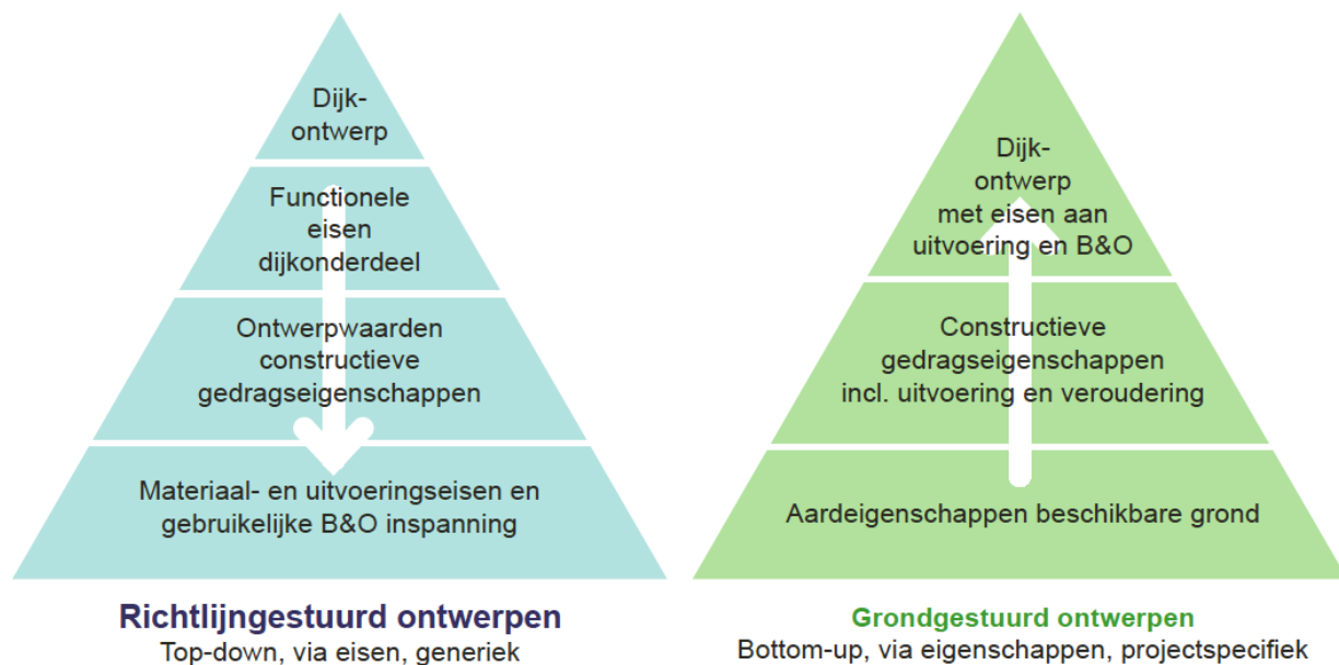
Figuur 6 Top-down ontwerpen volgens Piramide van Eisen (links) of bottom-up via eigenschappen (rechts) waarmee de verschillen in beeld zijn
