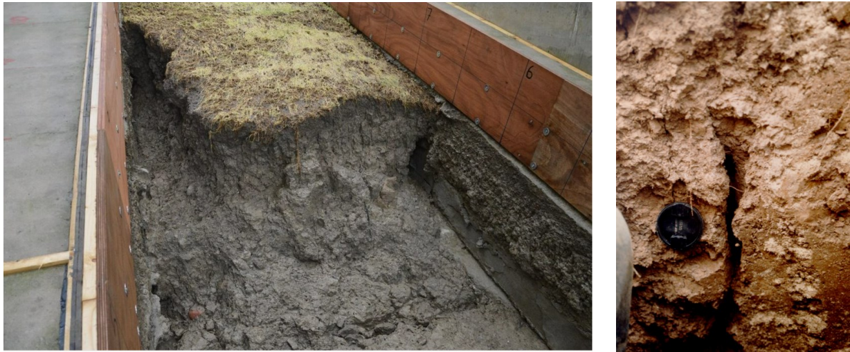
Foto 3 Voorbeelden van structuur in klei: Blija klei in Deltagoot (links [64]) en kleibekleding van de Kandiadijk (rechts, foto G.A.M. Kruse, 1981)
