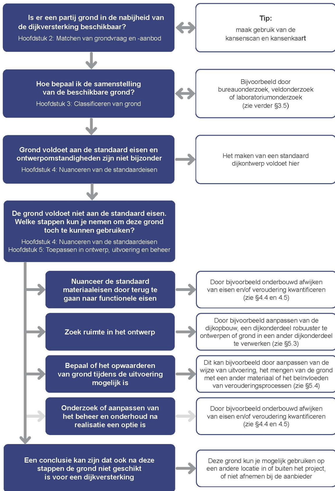
Figuur 1 Stroomschema toepassen gebiedseigen grond in dijkversterking voor gebruik van het Technisch kader
