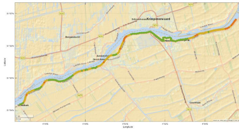
Figuur B.19 Overgangskansen voor GEBU na leiding falen voor dijktraject 15-2.
