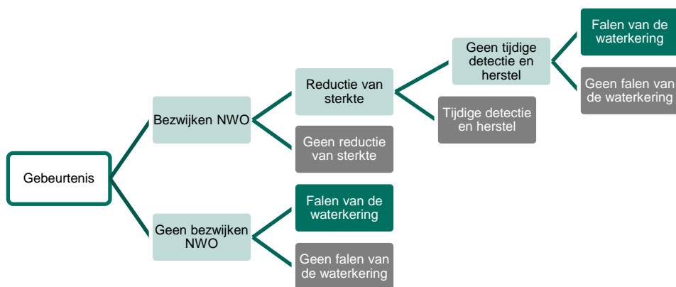
Figuur 2-2: Algemeen faalpadenboom waterkering met NWO
