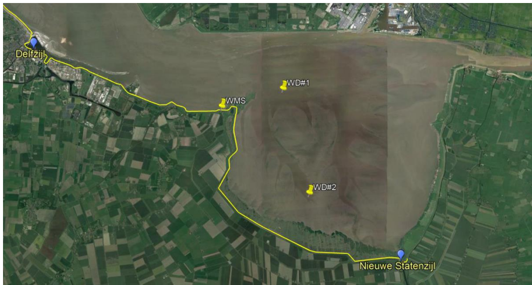
Figuur 15: Overzicht achterste deel van het Eems-Dollard-estuarium met mogelijke locaties van een extra windmeetstation (WMS) en twee nieuw te plaatsen golfmeetboeien (WD#01 en WD#02)
