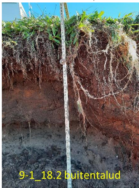
Figuur A.4 Bodemprofiel 9-1 18.2 buiten stroken 2-1 buitentalud en 2-2 binnentalud (boringen gestoken voorafgaand aan de erosieproef).
