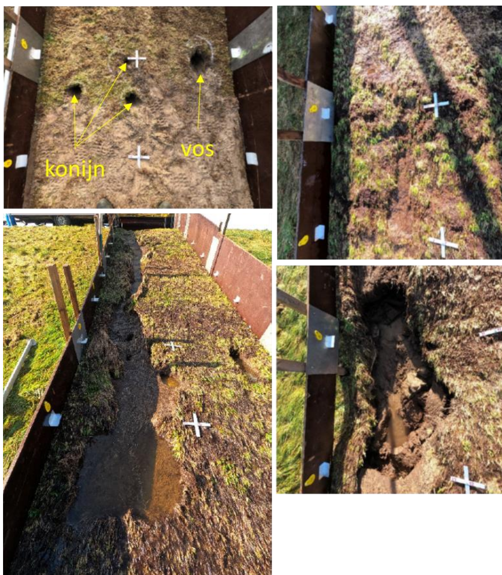
Figuur B.5 Aangebrachte schade vak 11 (linksboven), eerste schade vak 5 na 2,5 uur GO100_1,0 (rechtsboven), 0,25 uur GO190_1,0 (linksonder) en falen na 1 uur GO190_1,0 in vak 10 (rechtsonder).
