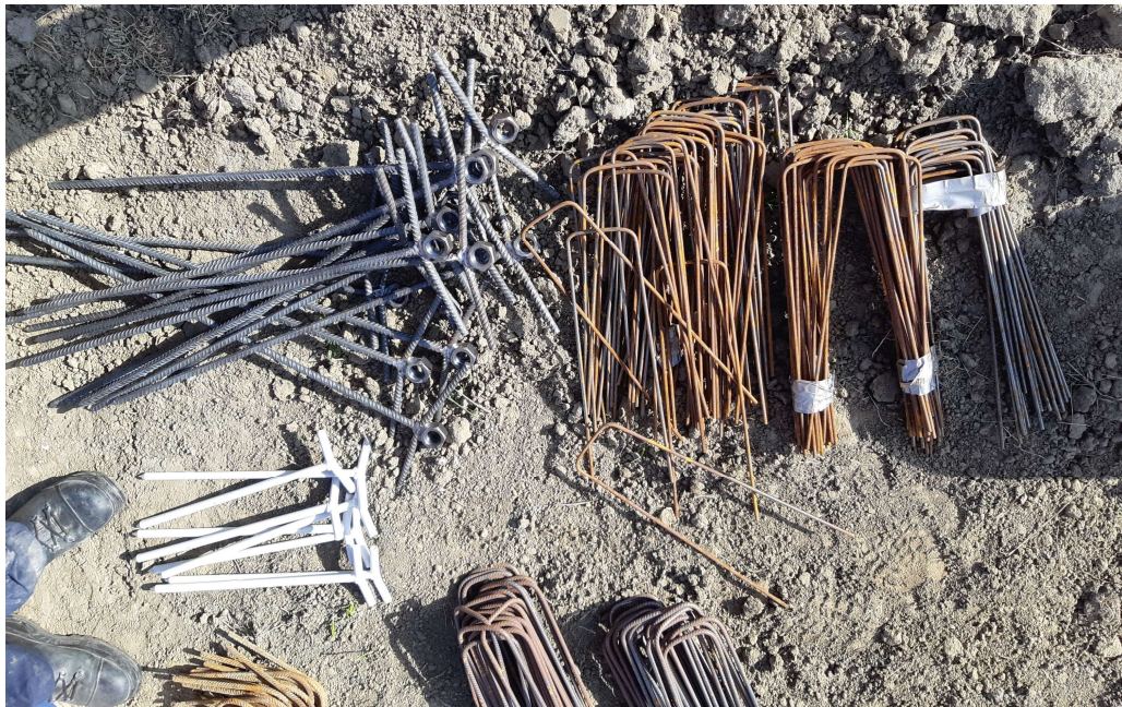
Figuur 34: verschillende soorten spelden (Y-pins) en haarspelden (U-pins) van betonstaal en "zachtstaal". (foto: Ulrich Förster)
