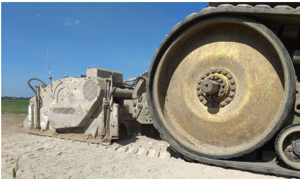
Figuur 32: mengwoeler voor stabilisatie van de toplaag op de kruin. (foto: Rimmer Koopmans)
