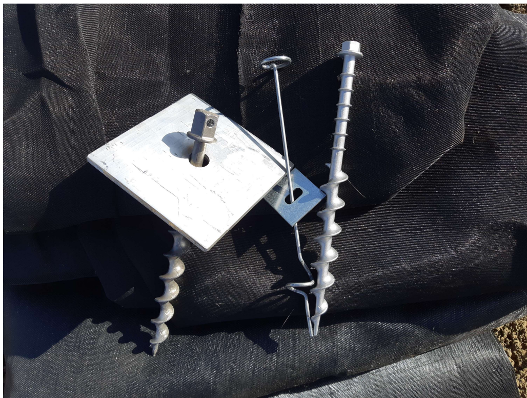
Figuur 35: Schroefpennen met ring (van links naar rechts Wormi, Gripple, Peggypeg). (foto: Ulrich Förster)
