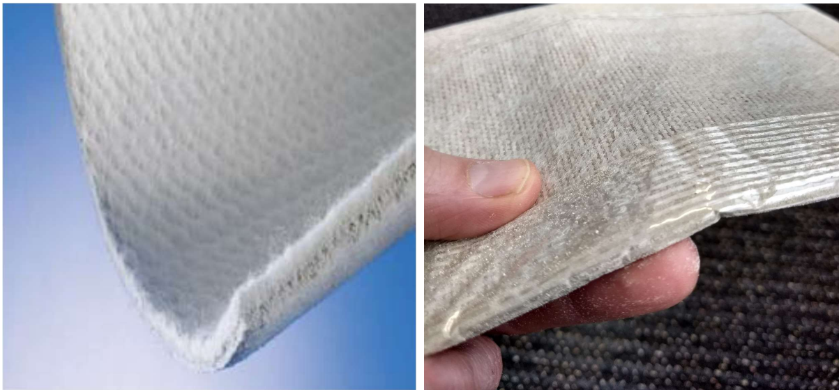
Figuur 5: GCL van non-woven (links) en weefsel (rechts).
