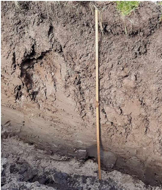
Figuur 2-4: Foto van profielkuil. Bovenin de zodelaag, met daaronder de fijne losse structuur tot circa 0,35 m - mv. Daaronder wordt de structuur grover en steeds dichter. Direct boven het dijkzand is de klei vrijwel massief [11]
