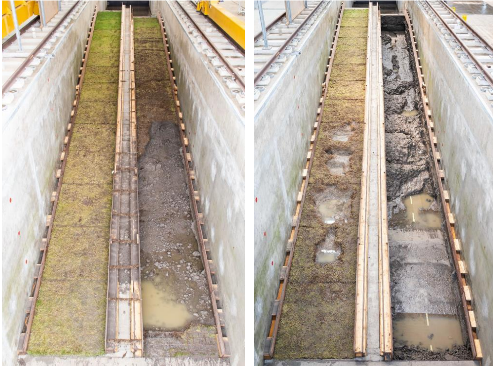
Erosiekuil aan Dollardzijde na 12 uur
