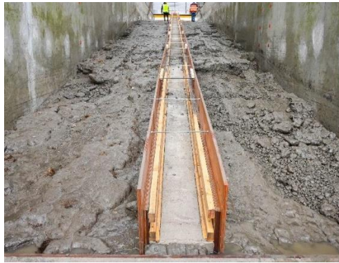
Klei erosie na 4 uur
