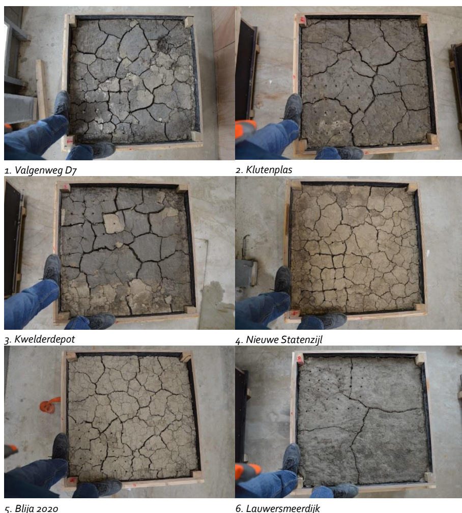
Figuur 2-13: Eindsituatie bakken klei na versnelde blootstelling seizoenen [13]
