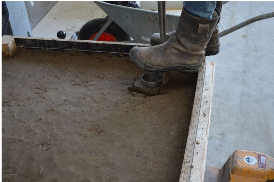
Fig. A-2 Steekringmonster na het aanbrengen van de klei in de bak
