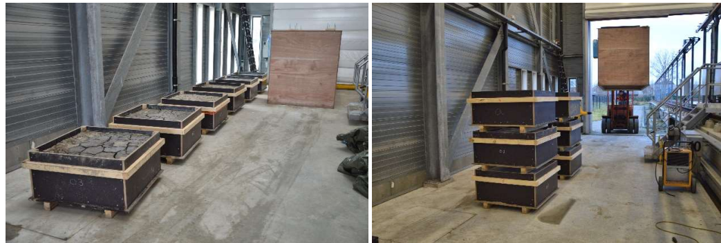
Figuur 3.2 Bakken met klei staan tijdens het natte seizoen naast de klimaatkamer (links) en worden voor het koude en warme seizoen opgestapeld waarna de klimaatkamer eroverheen gezet wordt (rechts).
