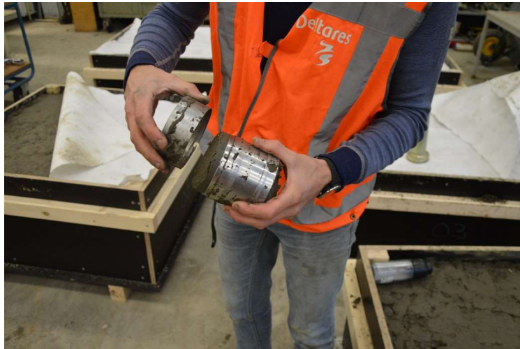
Figuur 2.5 Steekringmonster voor bepalen van verdichting
