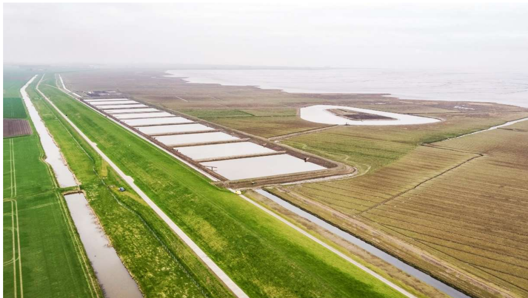
Figuur 2.2 Kleirijperij op de kwelder bij de Klutenplas, waar slib uit de polder Breebaart wordt gerijpt (kleisoort nr. 2) en klei uit de ringdijk is gebruikt, die uit de kwelder is gehaald voor het maken van de Klutenplas (kleisoort nr. 3)
