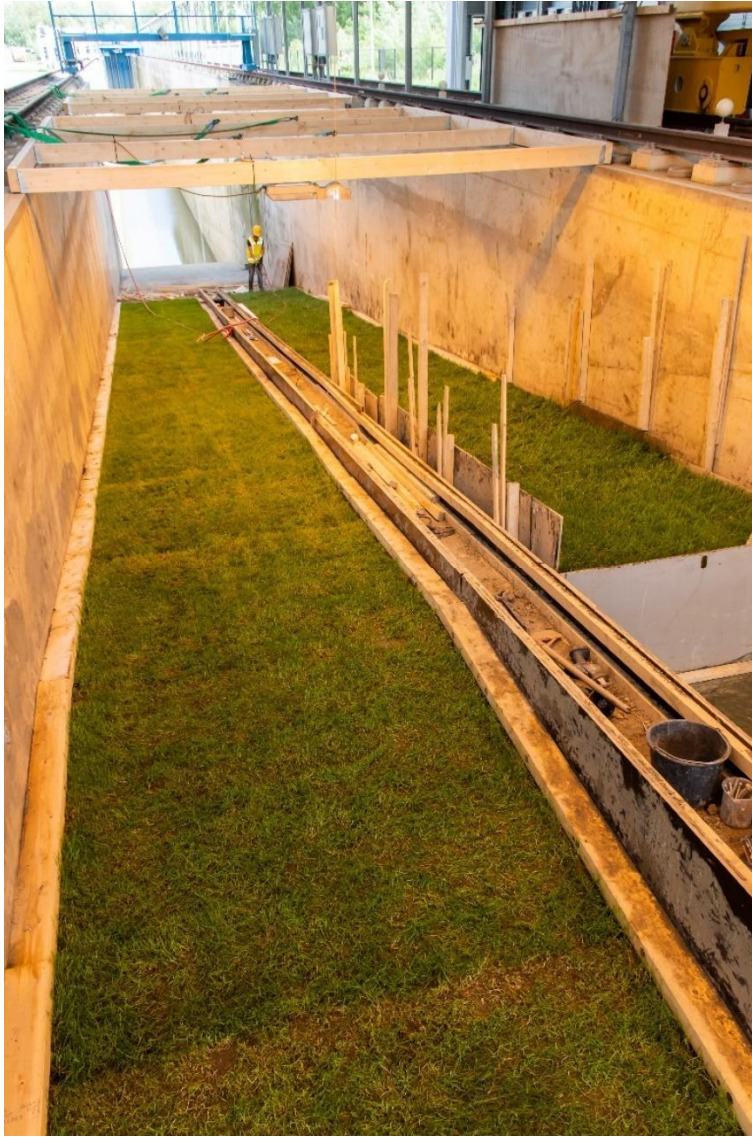
Figuur B.100 Extra verlichting m.b.v. groeilampen boven het gras om het gras in de hal in goede conditie te houden.
