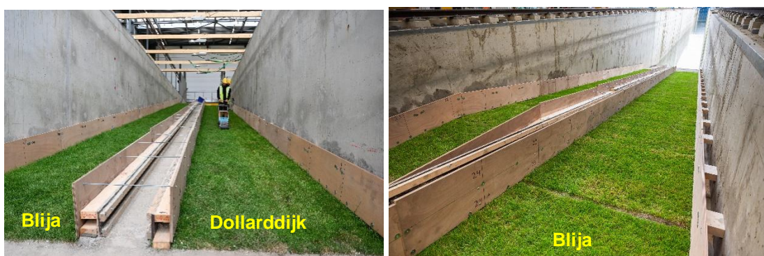
Figuur 3.1 Tweede modelopstelling in de Deltagoot met kleibekleding met gras van de Dollarddijk (halzijde) en een kleibekleding met gras van de Groene Dijk bij Blija (meetcabinezijde)
