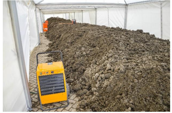
Figuur 2.8 Klei op het Deltagoot terrein: links de klei van de Klutenplas die wordt afgedekt, rechts de te natte klei van de Valgenweg in tenten met verwarming om te drogen.
