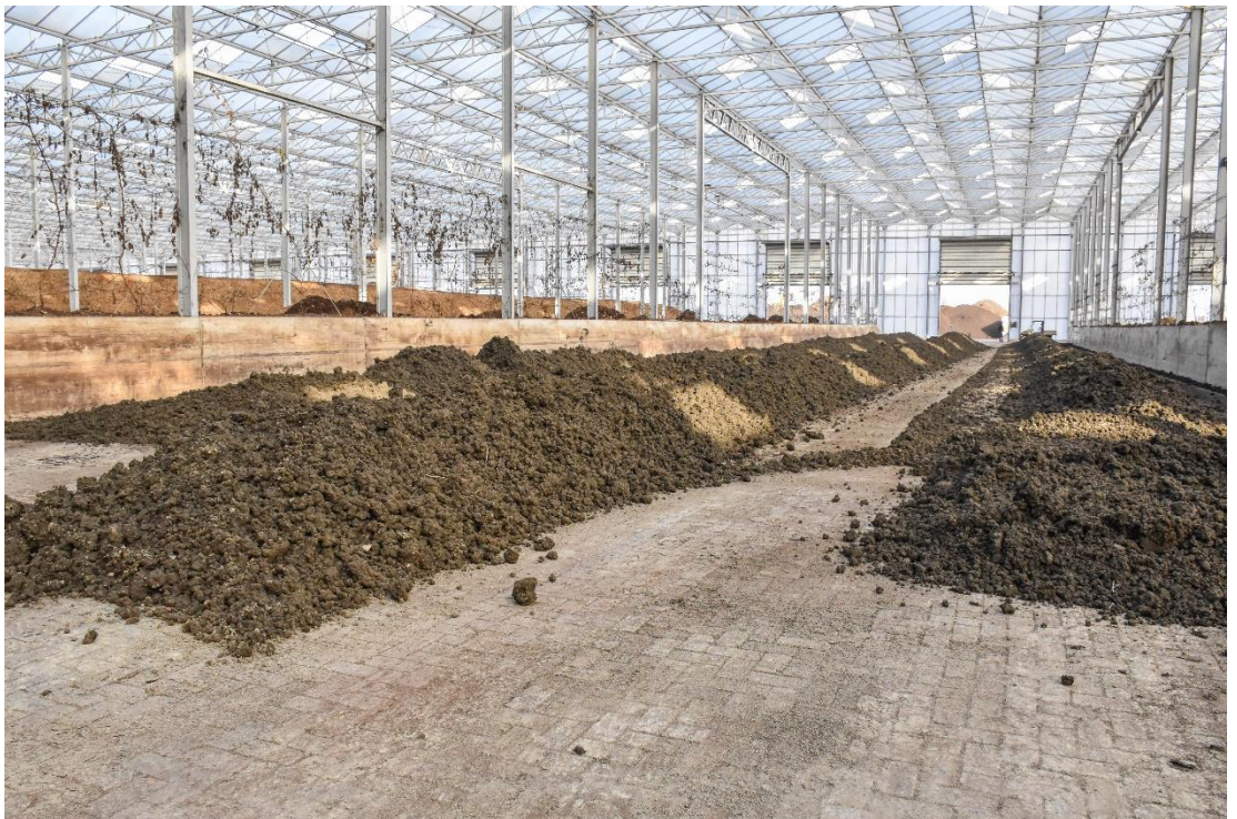
Figuur B.13 De droging in de tenten bleek onvoldoende. Daarom is de Valgenwegklei verplaatst naar een kas in Bleiswijk waar het 7 tot 12 dagen heeft kunnen drogen. Met een speciale machine zijn de ruggen dagelijks omgezet voor een gelijkmatige droging.
