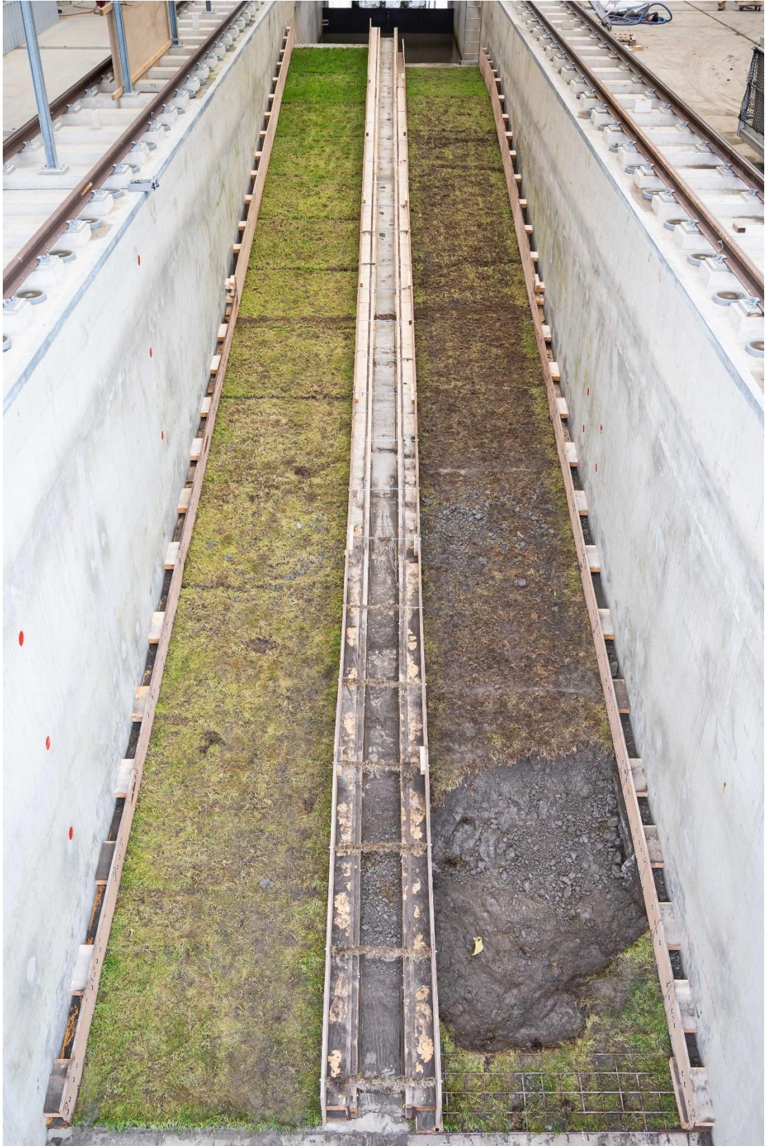
Figuur B.113 Erosiekuil aan de Dollardzijde na proef B2_06. Er is geen erosie aan de Blijzijde.
