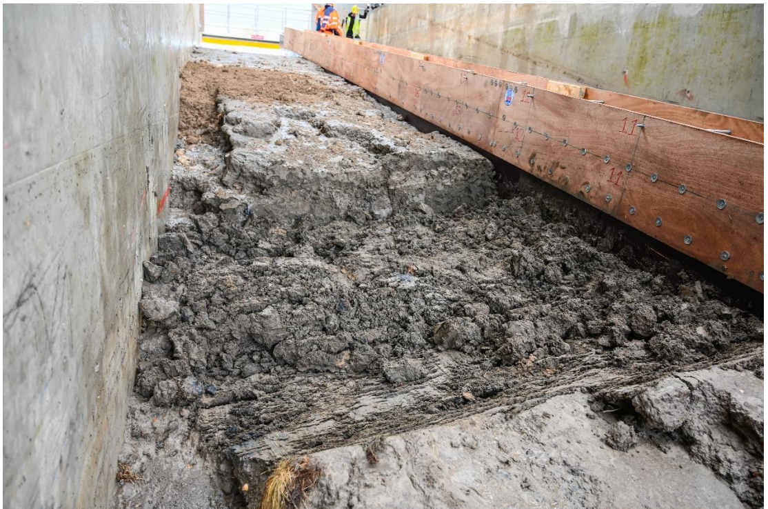
Figuur B.54 Resultaat van het gemaakte gat in de Klutenplasklei.
