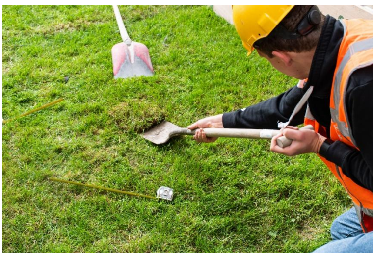
Figuur 5.1 Aanbrengen van kunstmatige schade in de grasmat (20x20 cm 2 en 5 cm diep)
