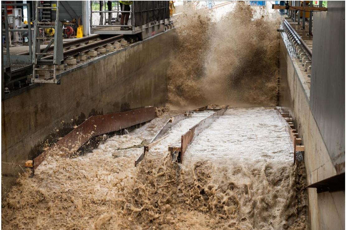
Figuur B.135 Brekende golf en overslag tijdens proef B2_14.
