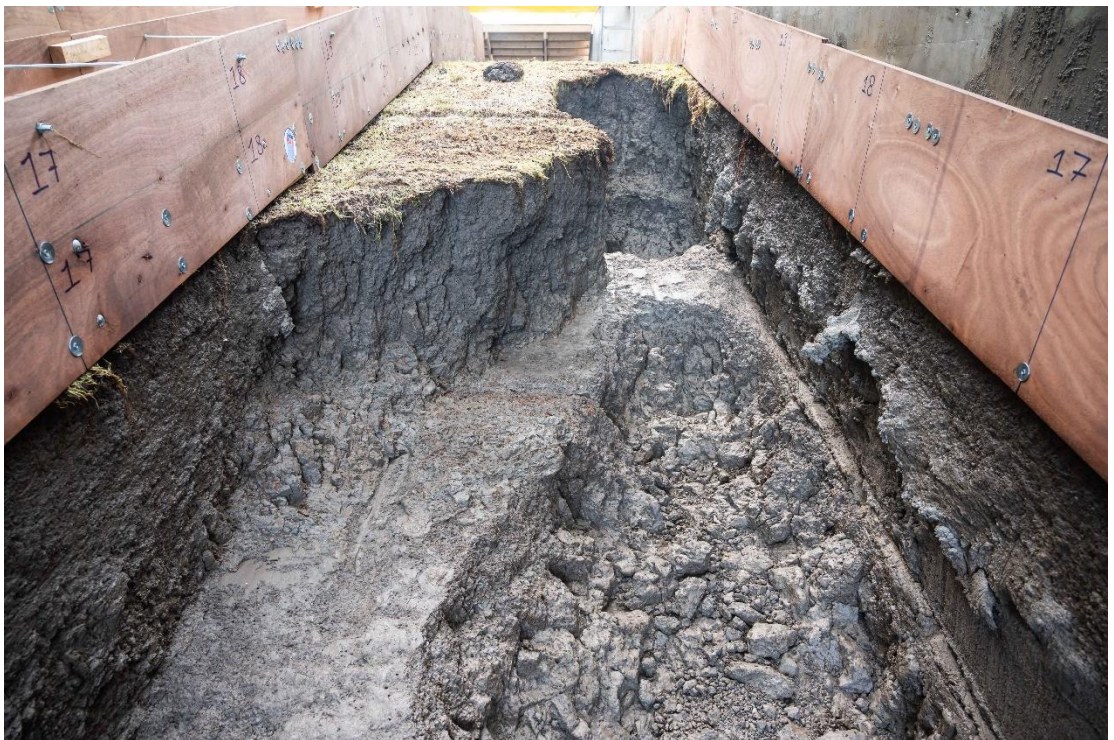
Figuur B.128 De erosieklijf aan de Dollardzijde heeft bijna de kruin bereikt na proef B2_12.
