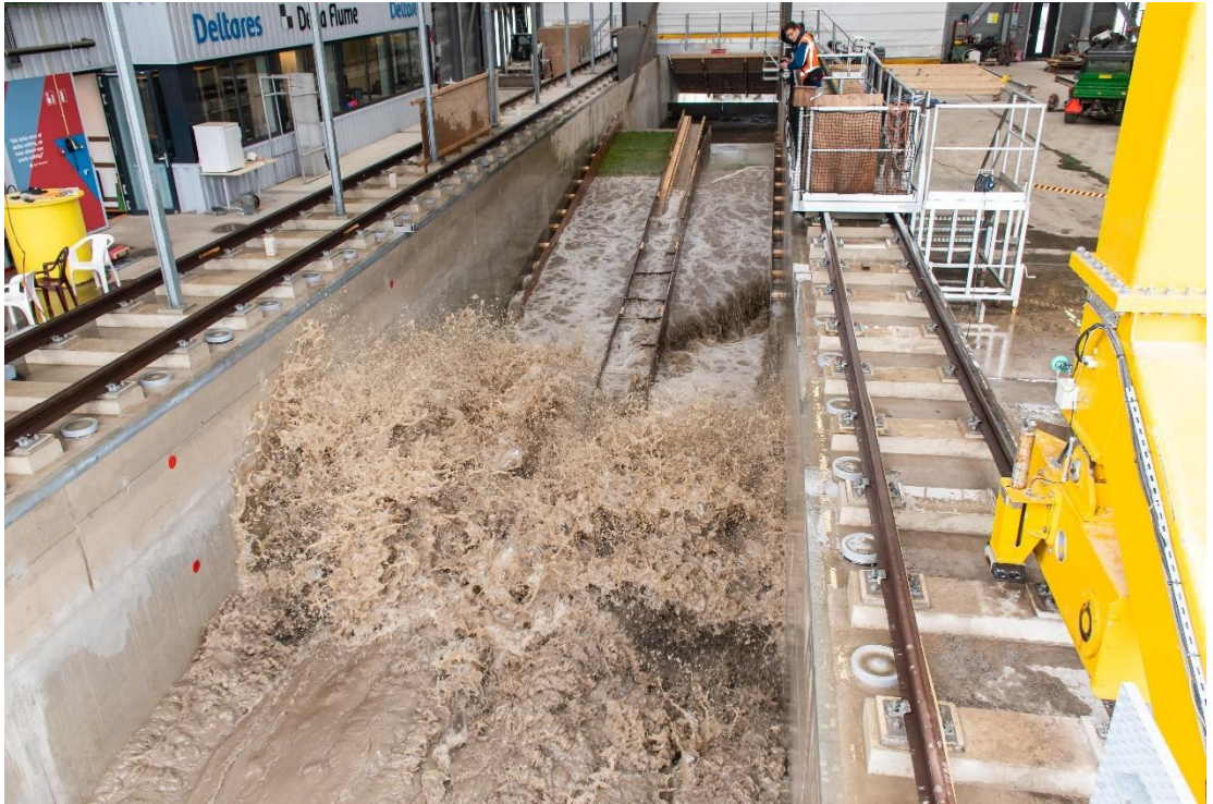
Figuur B.124 Brekende golf tijdens proef B2_11. De klif aan de Dollardzijde is gegroeid tot boven de waterlijn.
