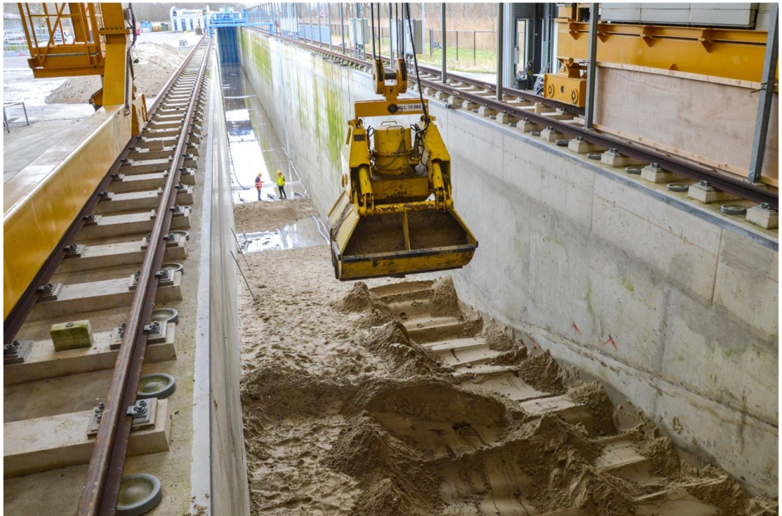
Figuur B.1 De kern van de dijk bestaat uit zand dat is aangebracht met een 50 m lang talud van 1:7.
