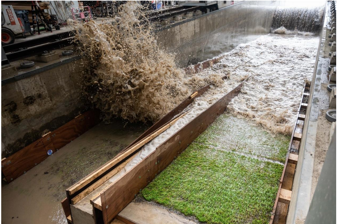
Figuur B.132 Brekende golven lopen hoog op tegen het talud en slaan tegen de klif aan de Dollardzijde.
