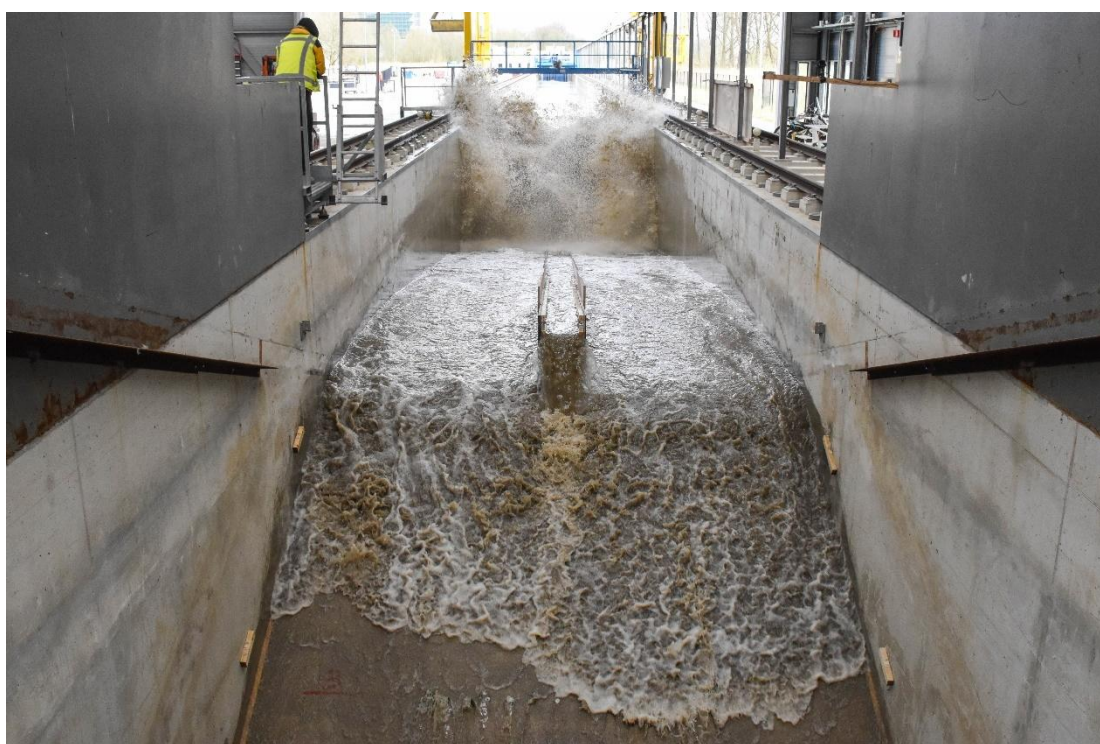
Figuur B.22 Brekende golf en overslag tijdens test B1_01.
