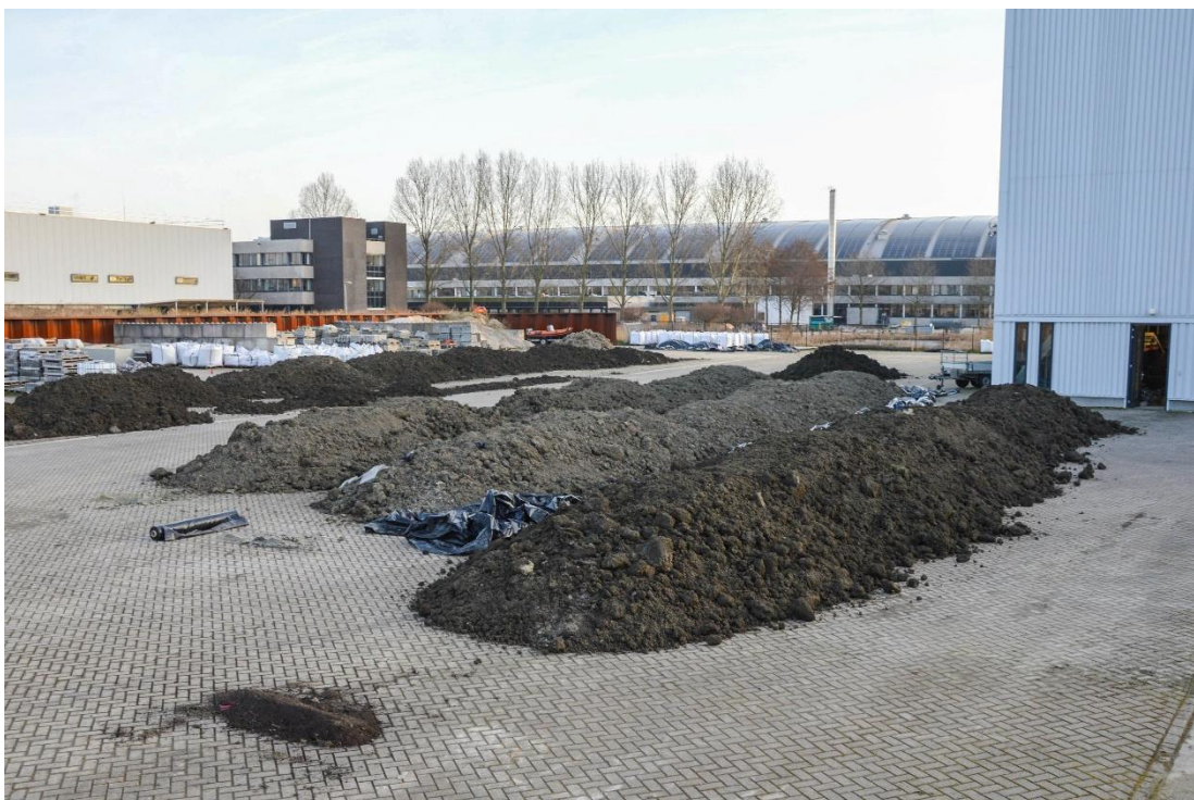
Figuur B.10 De geleverde klei op het Deltagooierrein. De eerste drie ruggen zijn van de Klutenplas. Achteraan de Valgenwegklei. De Klutenplasklei had het juiste vochtgehalte en is na aankomst daarom direct afgedekt.
