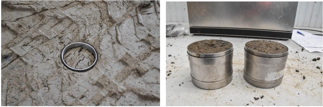
Figuur 2.12 Gestoken steekring in klei (links) en afgesneden steekringen (rechts) voor dichtheidsmeting.
