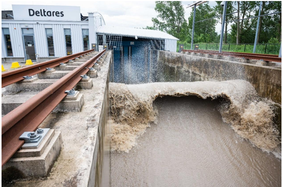
Figuur B.140 Brekende golf bij het golfschot tijdens proef B2_15.
