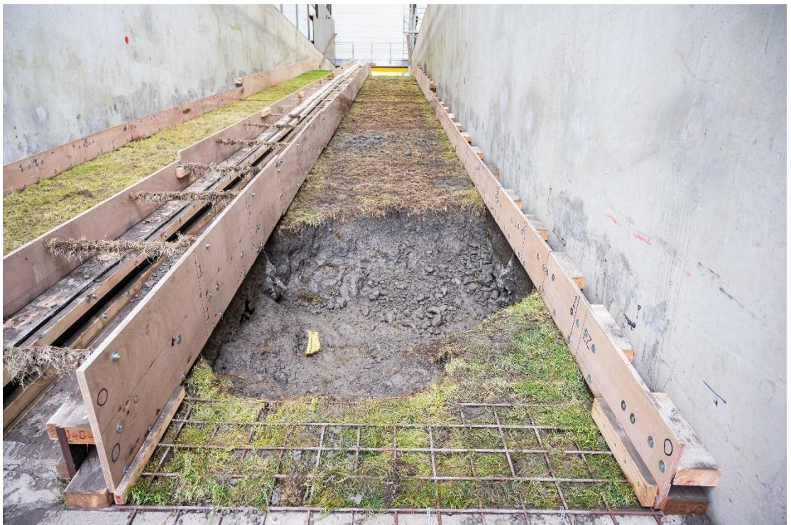
Figuur B.112 Erosie aan de Dollardzijde na test B2_06. Het kleine erosiegat na de vorige proef is snel gegroeid.
