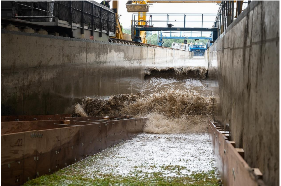
Figuur B.121 Brekende golven tijdens proef B2_10. Deze proef had een lagere golfhoogte ( H_{m0} = 1,5 m).
