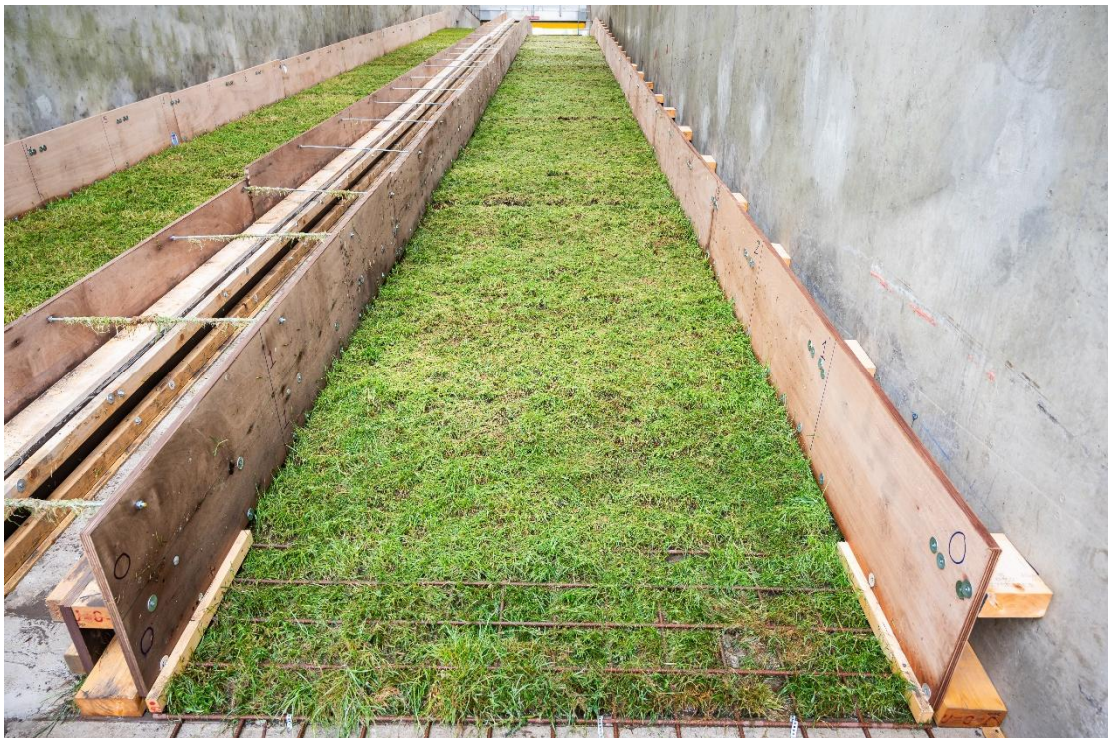
Figuur 3.18 Grasbekleding van Dollarddijk, waarbij de eerste 40 cm is opgebouwd uit kleine grasblokjes van 20 \times 30 \times 30 \text{ cm}^3 met een wapeningsnet erop.
