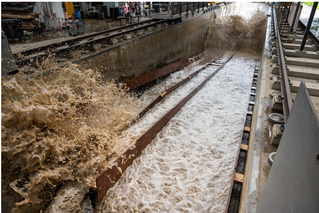
Figuur B.145 Brekende golf en overslag tijdens proef B2_17.
