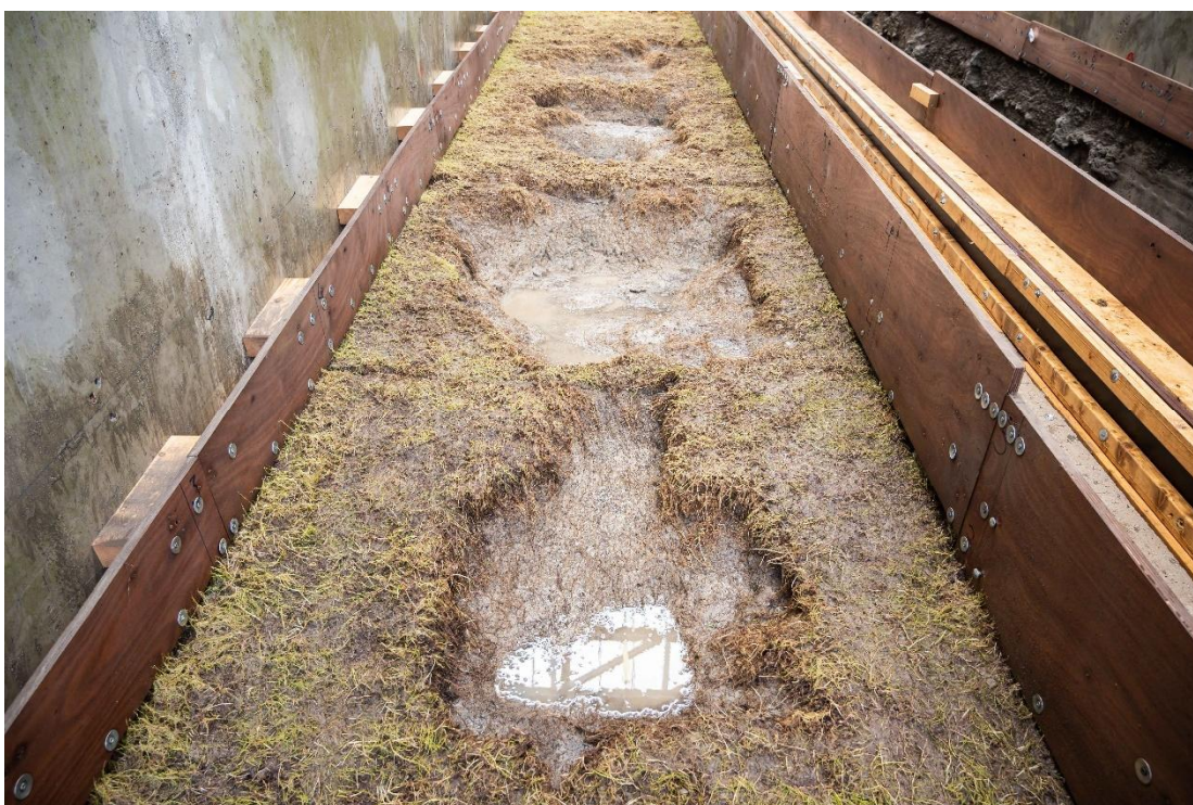
Figuur B.146 Opnieuw zijn de kunstmatige gaten aan de Blijzijde nauwelijks gegroeid.
