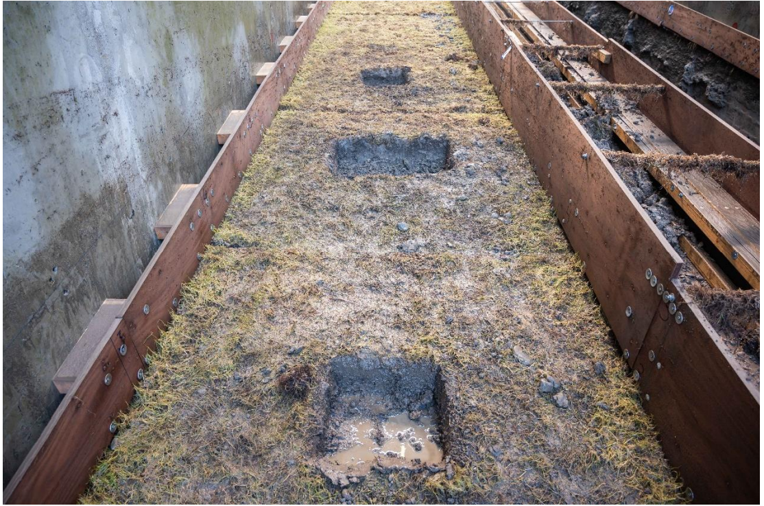
Figuur B.129 De kunstmatige gaten aan de Blijzijde zijn kunstmatig vergroot na proef B2_12. Daarnaast is er een gat bijgemaakt in het vierde kleiblok.
