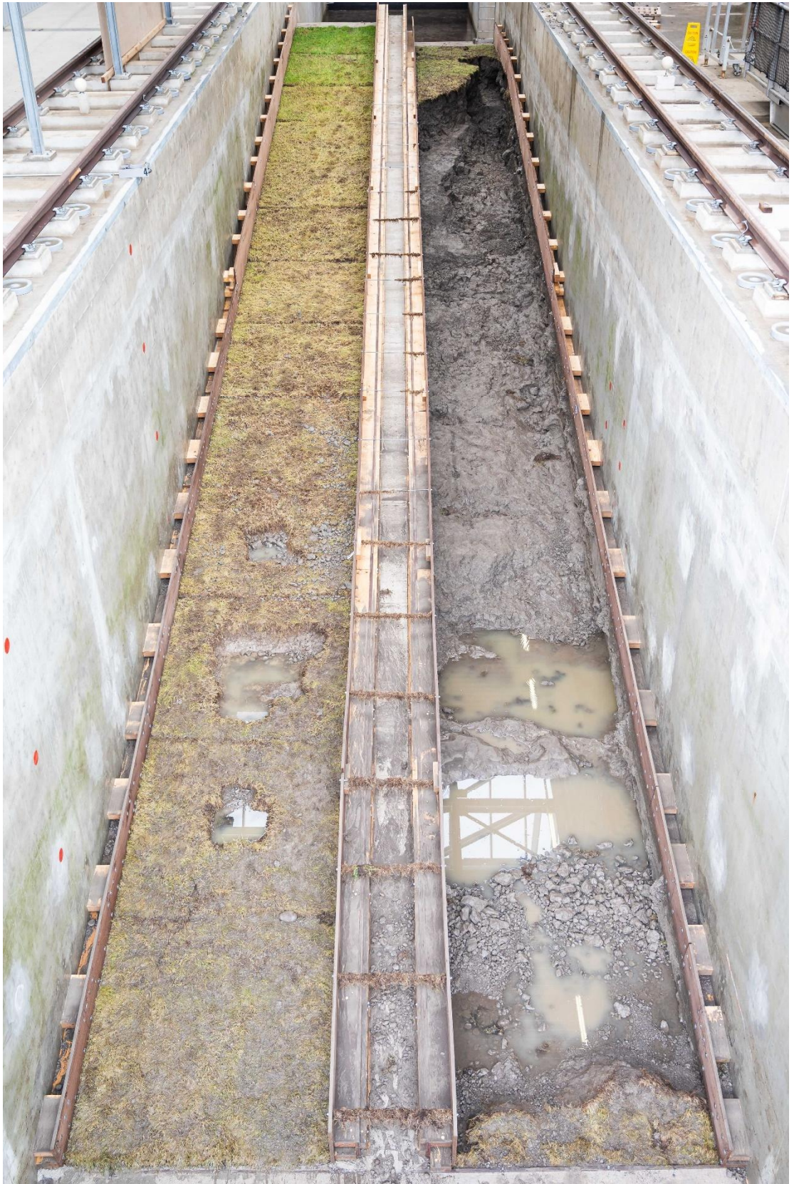
Figuur B.134 De kunstmatige gaten aan de Blijzijde zijn iets gegroeid. Aan de Dollardzijde is de erosie een stuk de kruin in gegroeid.
