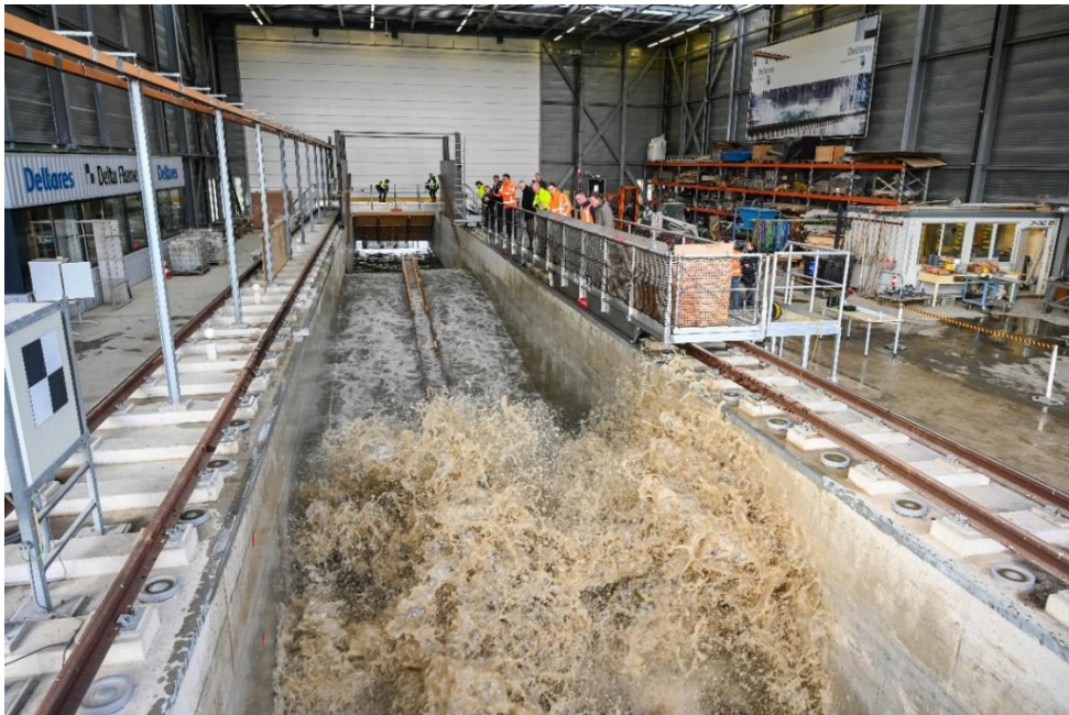
Golfbelasting op het kleitalud in de Deltagoot.
