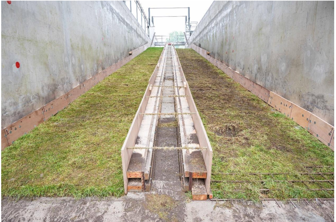
Figuur B.109. Na test B2_05. De kleine erosiekuiltjes aan de Dollardzijde zijn gegroeid tot een gat.
