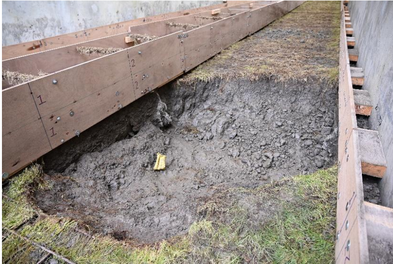
Figuur 5.4 Erosiekuil na proef B2_06 (na totaal 6,8 uur golven)
