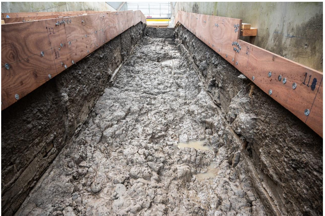
Figuur B.141 Na proef B2_15 is de klei aan de Dollardzijde bijna volledig weg. Alleen een deel van de onderblokken is nog niet weggeslagen.
