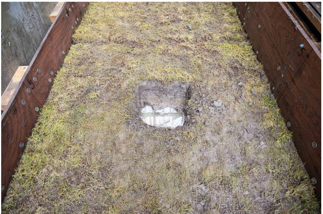
Figuur B.125 Het kunstmatige gat in de Blijaklei is kunstmatig vergroot na proef B2_11.
