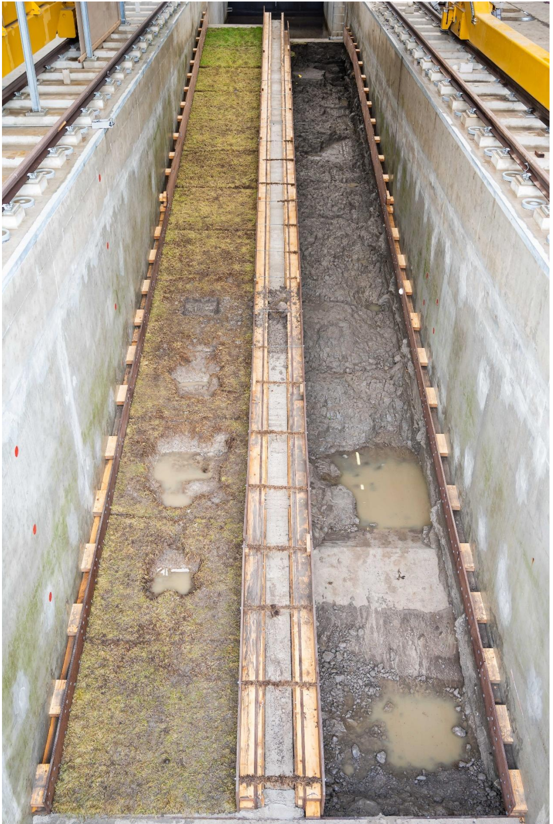
Figuur B.142 De erosie aan de Blijzijde is nauwelijks toegenomen in test B2_15. Aan de Dollardzijde is de erosie dieper geworden.
