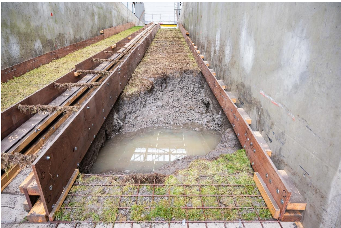
Figuur B.114 Erosie aan de Dollardzijde na proef B2_07. De klif start naar boven toe te groeien.
