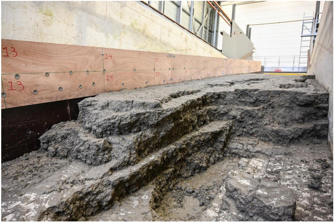
Figuur B.41 Valgenweg klifvorming na proef B1_07 met de aangebrachte kleilagen duidelijk zichtbaar.
