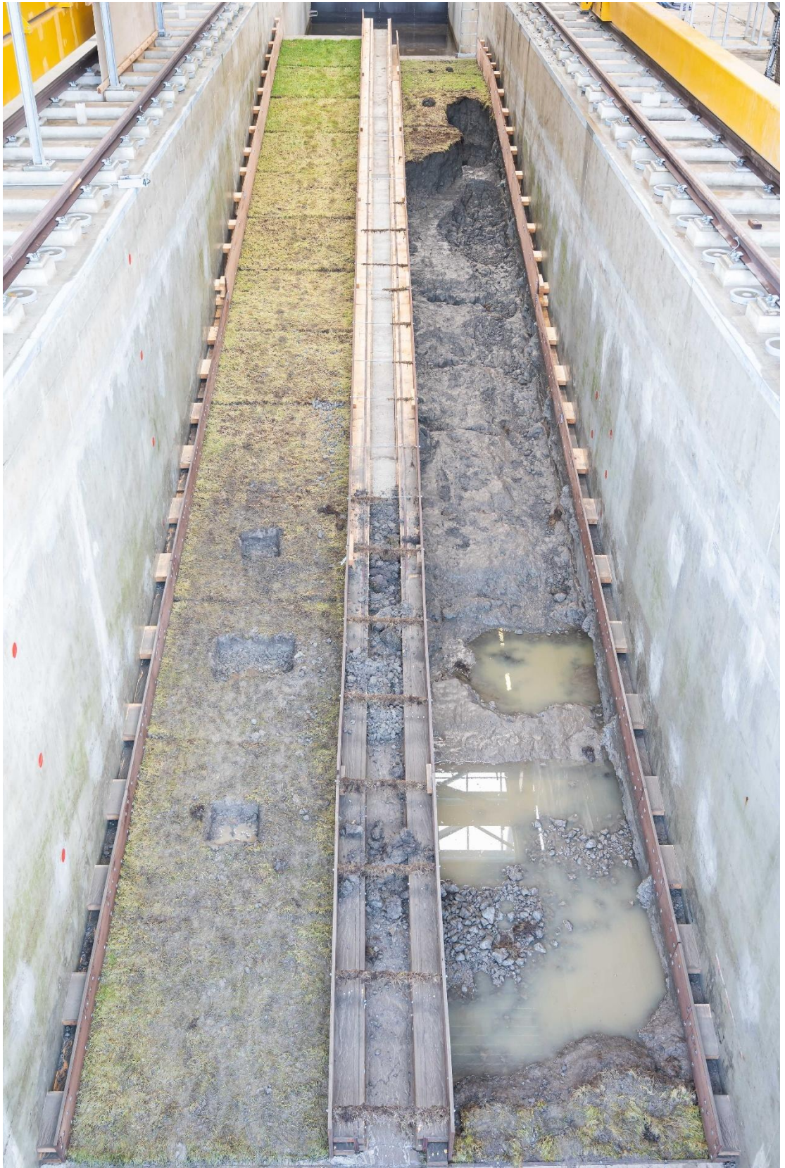
Figuur B.131 Tijdens proef B2_12 had de erosieklif aan de Dollardzijde bijna de kruin bereikt. Aan de Blijzijde was geen erosie en zijn daarom de kunstmatige gaten vergroot.
