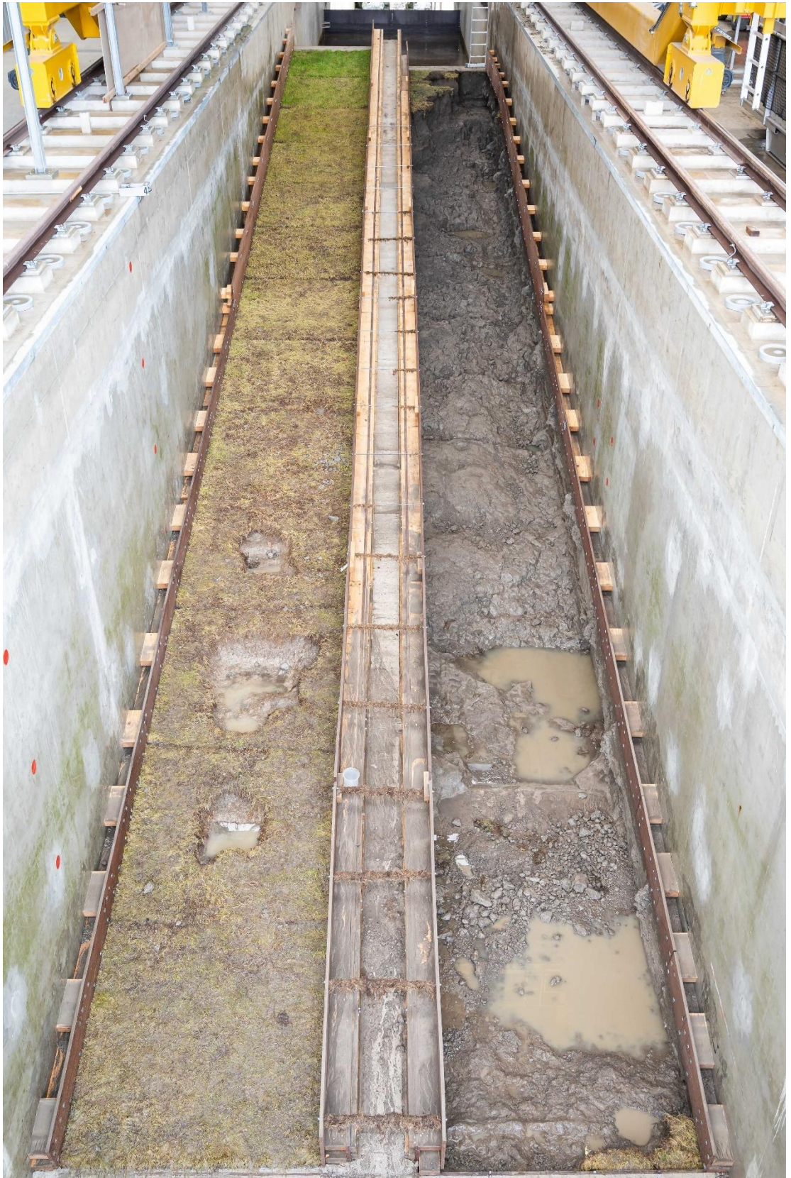
Figuur B.139 Erosie na proef B2_14. Aan de Dollardzijde is de kruin doorgebroken. Aan de Blijzijde is geen erosie.
