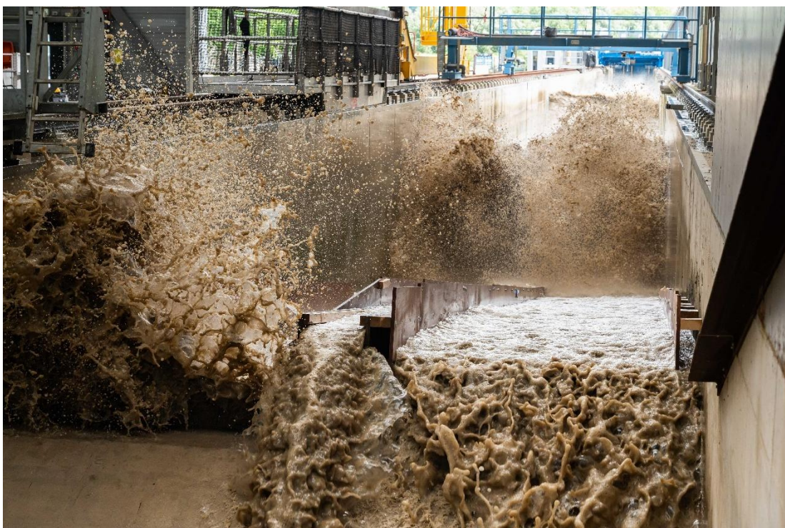
Figuur B.143 Brekende golf en overslag tijdens proef B2_16.
