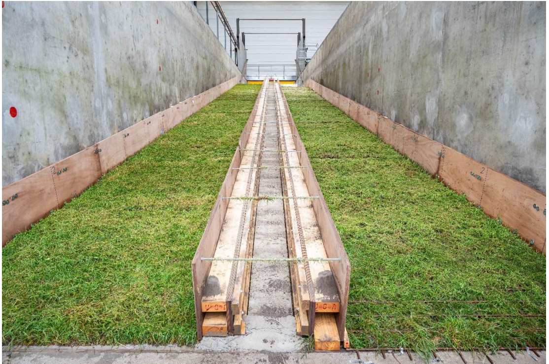
Figuur B.104 Situatie na test B2_02. Nog geen erosie.
