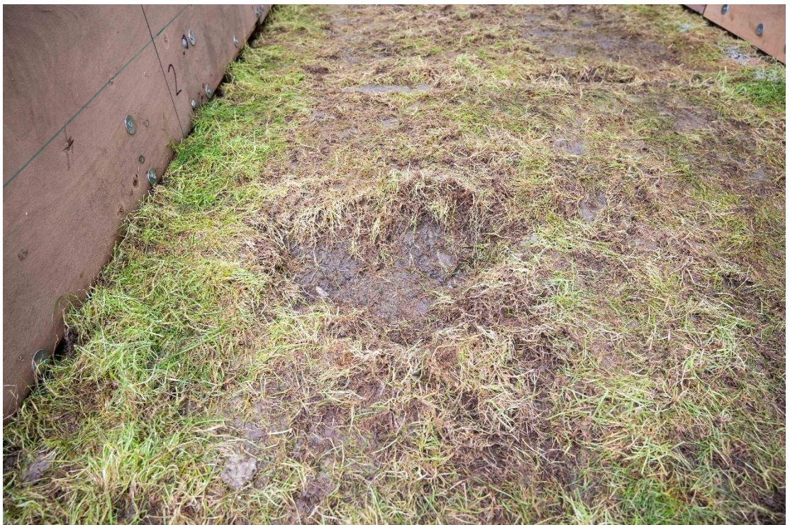
Figuur B.110 Eerste erosie gat aan de Dollardzijde in het eerste kleiblok.
