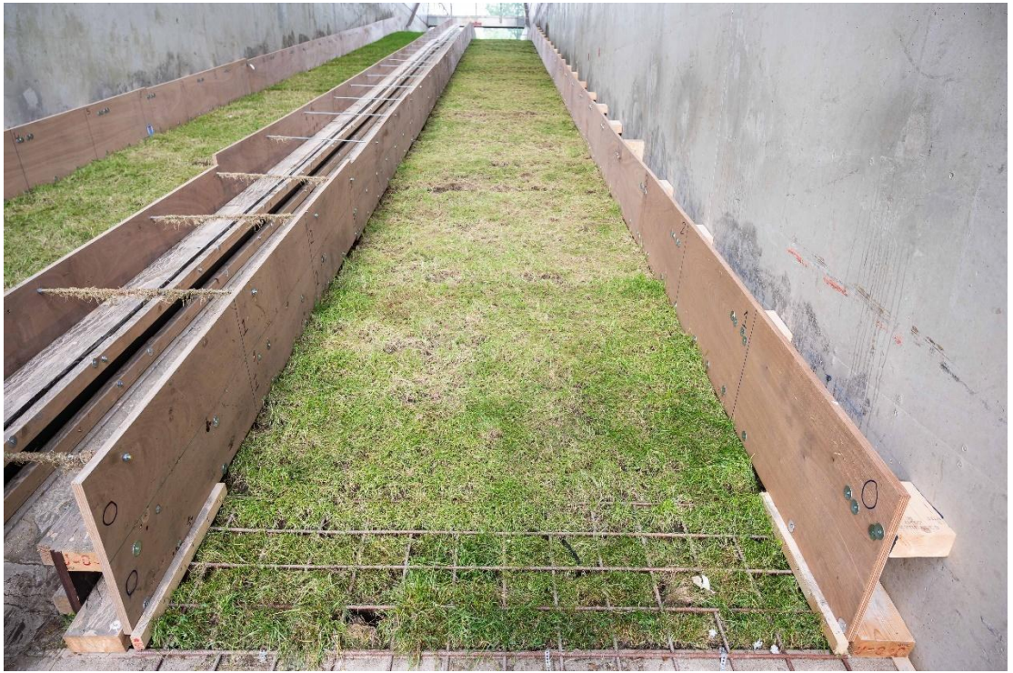
Figuur B.107 Situatie Dollardzijde na test B2_04. Er is een kalere plek te zien in het eerste kleiblok. Onder dit gras zitten de eerste klei-erosiekuiltjes.
