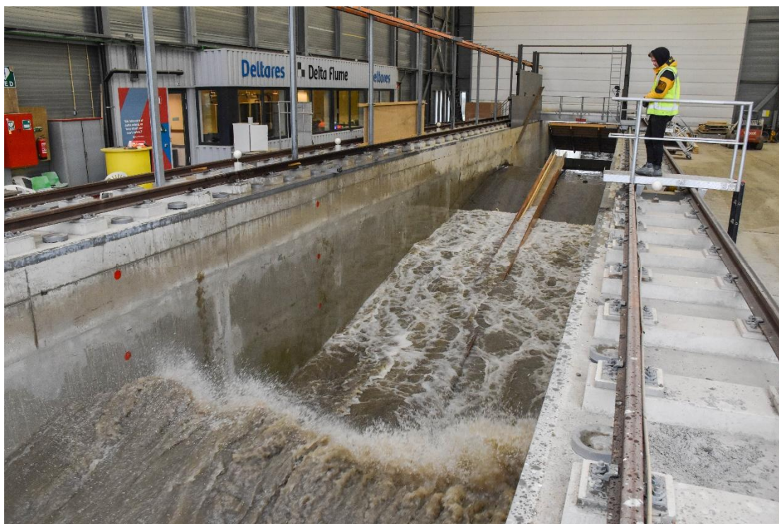
Figuur B.21 Brekende golf tijdens test B1_01.
