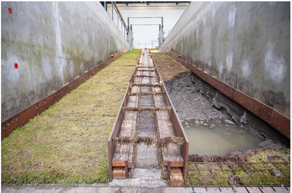
Figuur B.120 Tijdens proef B2_09 is door de lagere golfhoogte de erosie niet toegenomen.
