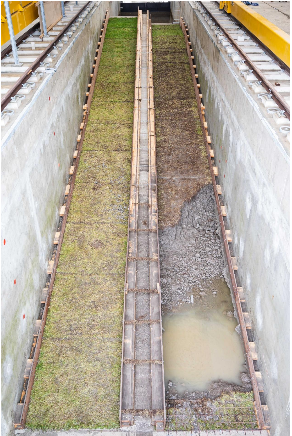
Figuur B.118 Erosiekuil aan de Dollardzijde is gegroeid tijdens proef B2_08. Er is geen erosie aan de Blijzijde.
