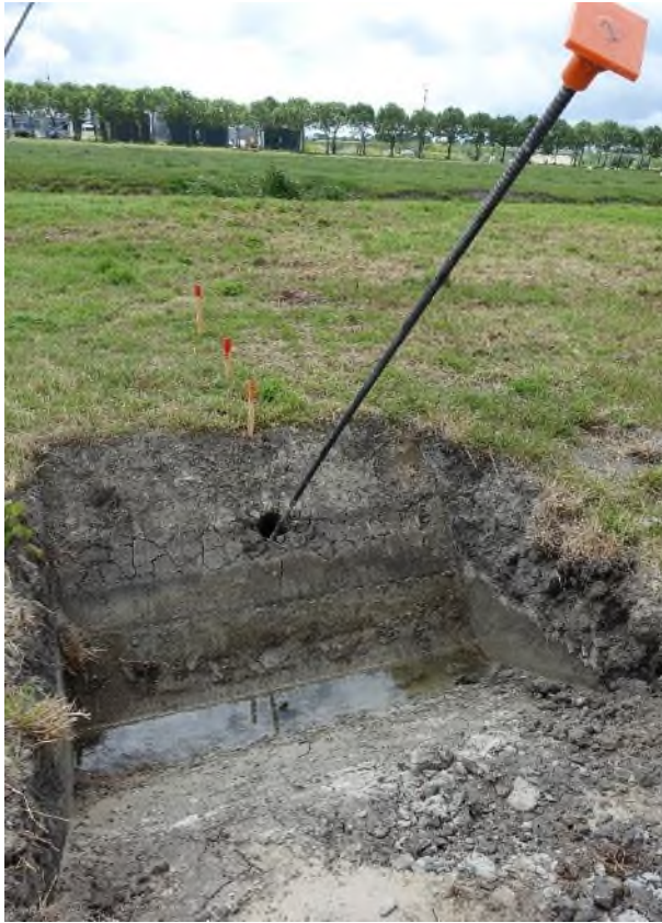
Figuur 4-14: Proefopstelling JLD-Dijkstabilisator in Purmerend (foto 22 juni 2018). Zichtbaar is het gat van de drijfstang en de trekstang daarin. Het LDE-element is niet aangebracht. Het zichtbare water is freatisch grondwater.
