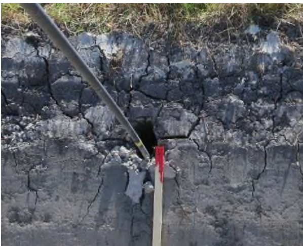
Figuur 4-19: Boorgat van drijfstang met alleen trekstang
