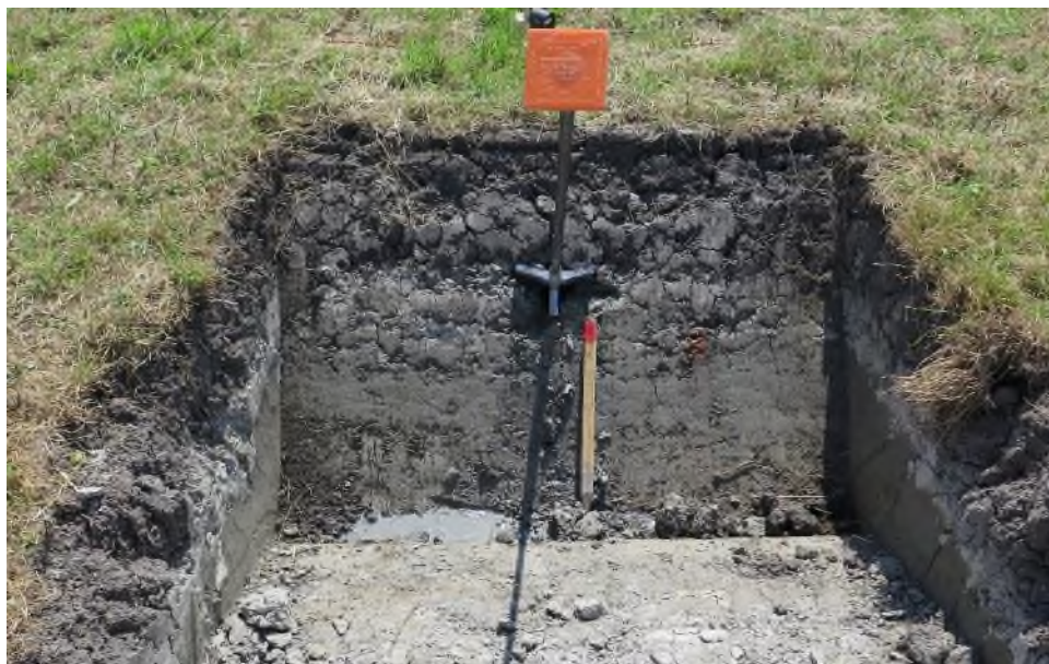
Figuur 4-16: JLD11, waar uittredend water is geconstateerd
