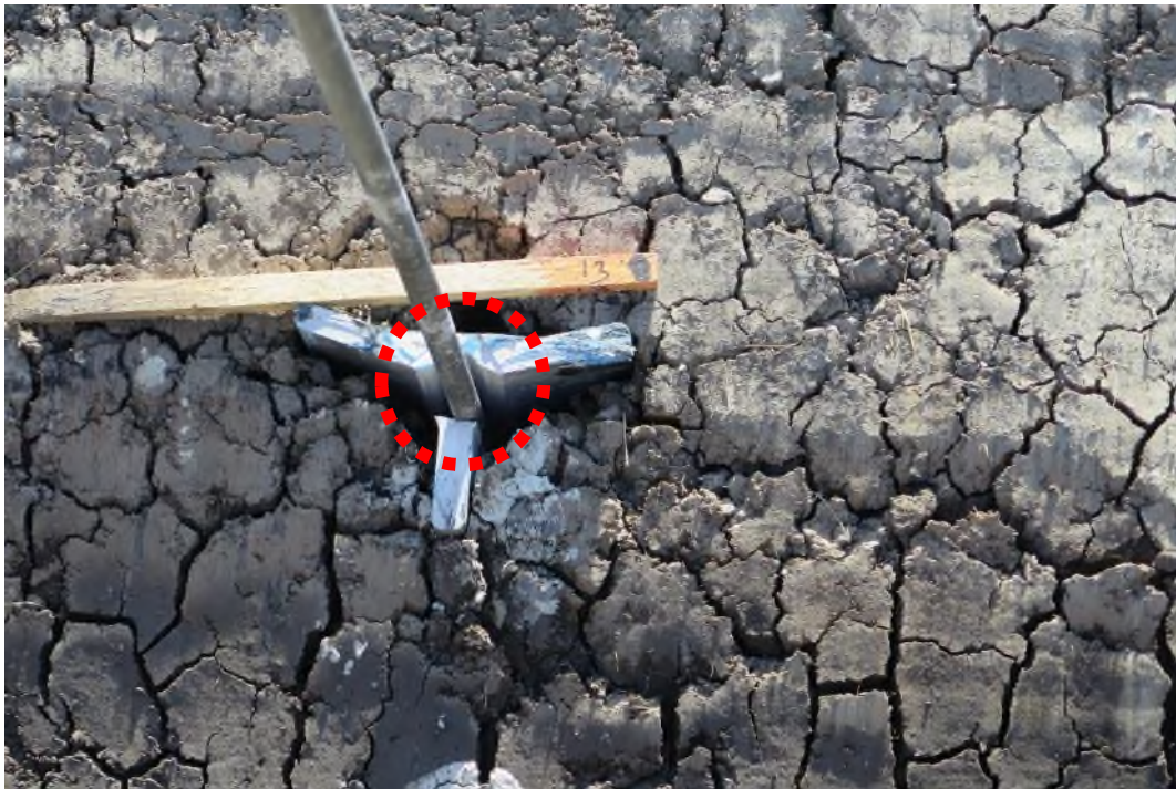
Figuur 5-6: Boorgat met LDE-vinelement, zichtbaar is dat het gat van de drijfstang nog deels intact is (rode cirkel)
