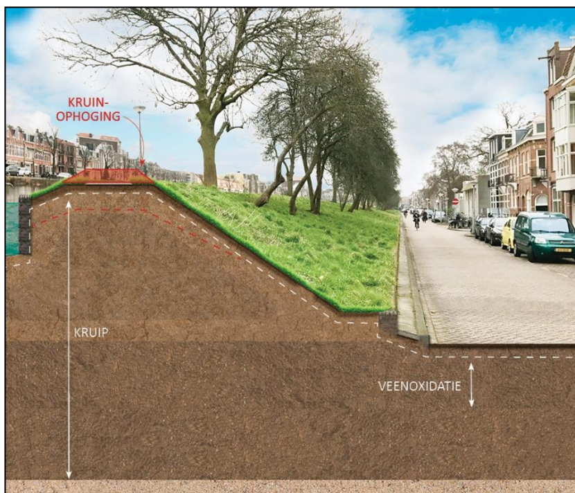
Figuur 2-2 Schematische weergave van de vervormingen van een groene dijk
