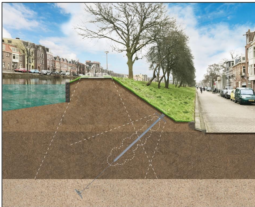
Figuur 2-4 Schematische weergave van de spanningsverspreiding voor een dijk versterkt met JLD-Dijkstabilisator
