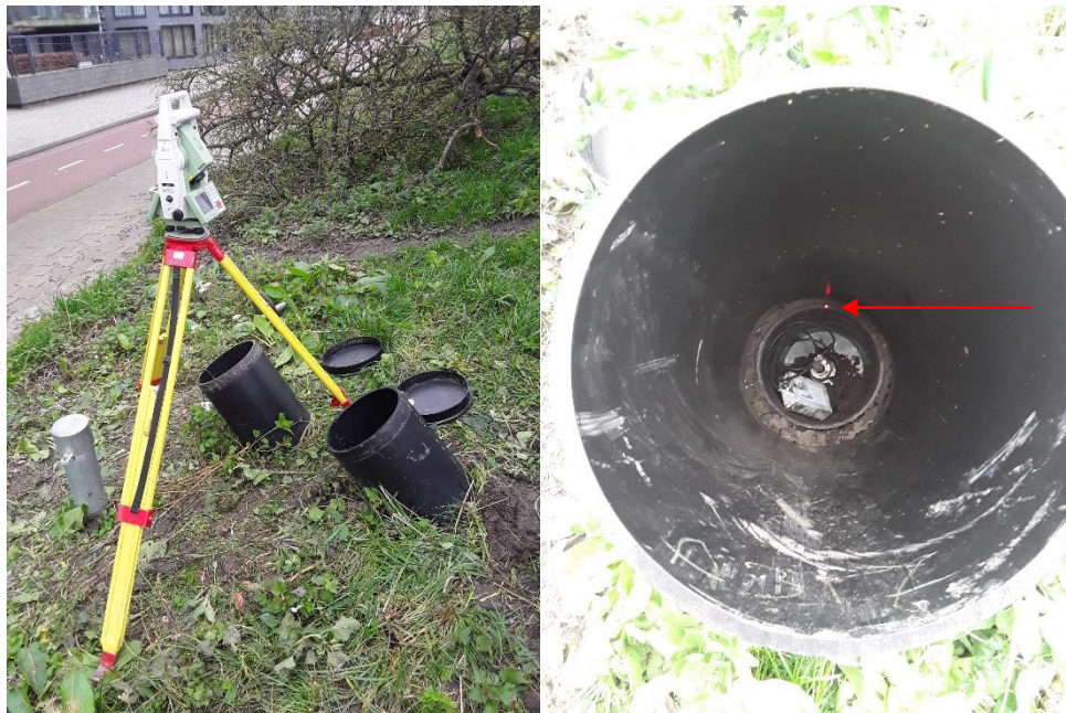
Figuur 2-1 Foto's meetopstelling (links) en de locatie van het meetpunt, zichtbaar door de rode licht van de laser (rechts)
