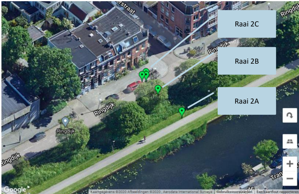
Figuur 3-20: Overzicht locatie peilbuizen en waterspanningsmeters raai 2
