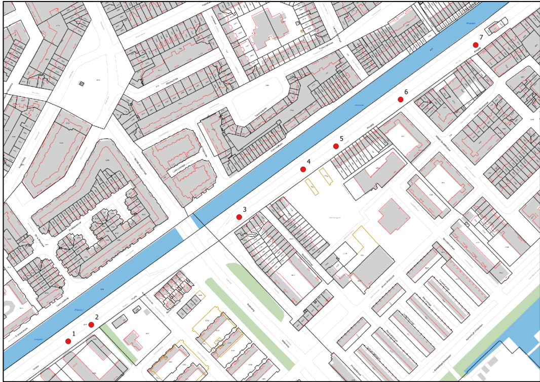
Figuur 1-2: Overzichtssituatie meetlocaties. De dwarsprofielen zijn ingemeten op locatie 1 t/m 7. De kopplaten zijn ingemeten op locatie 2 t/m 6.
