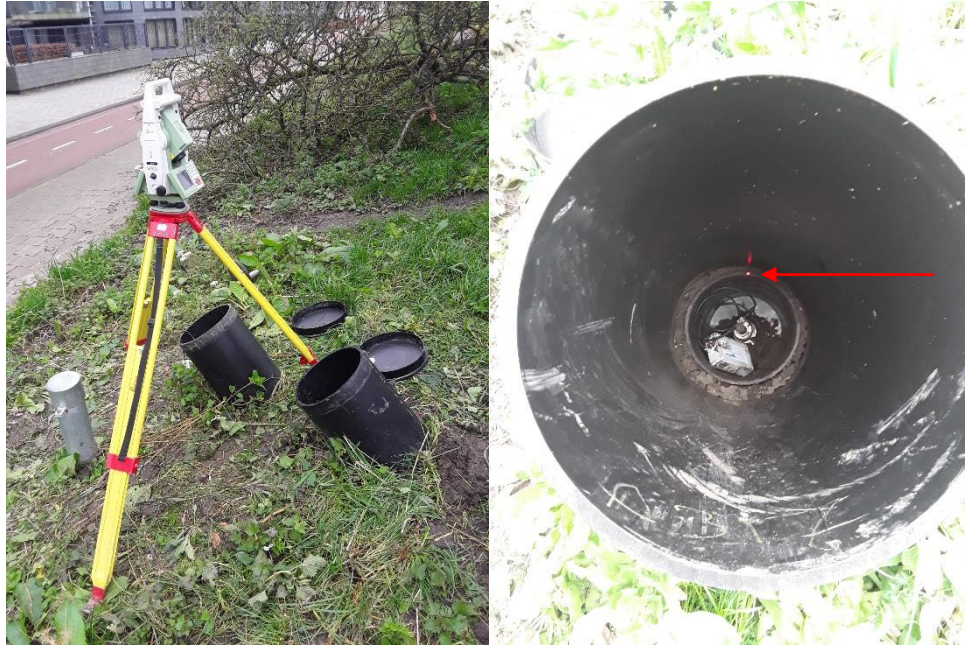
Figuur 3-17 Foto's meetopstelling (links) en de locatie van het meetpunt, zichtbaar door de rode licht van de laser (rechts)
