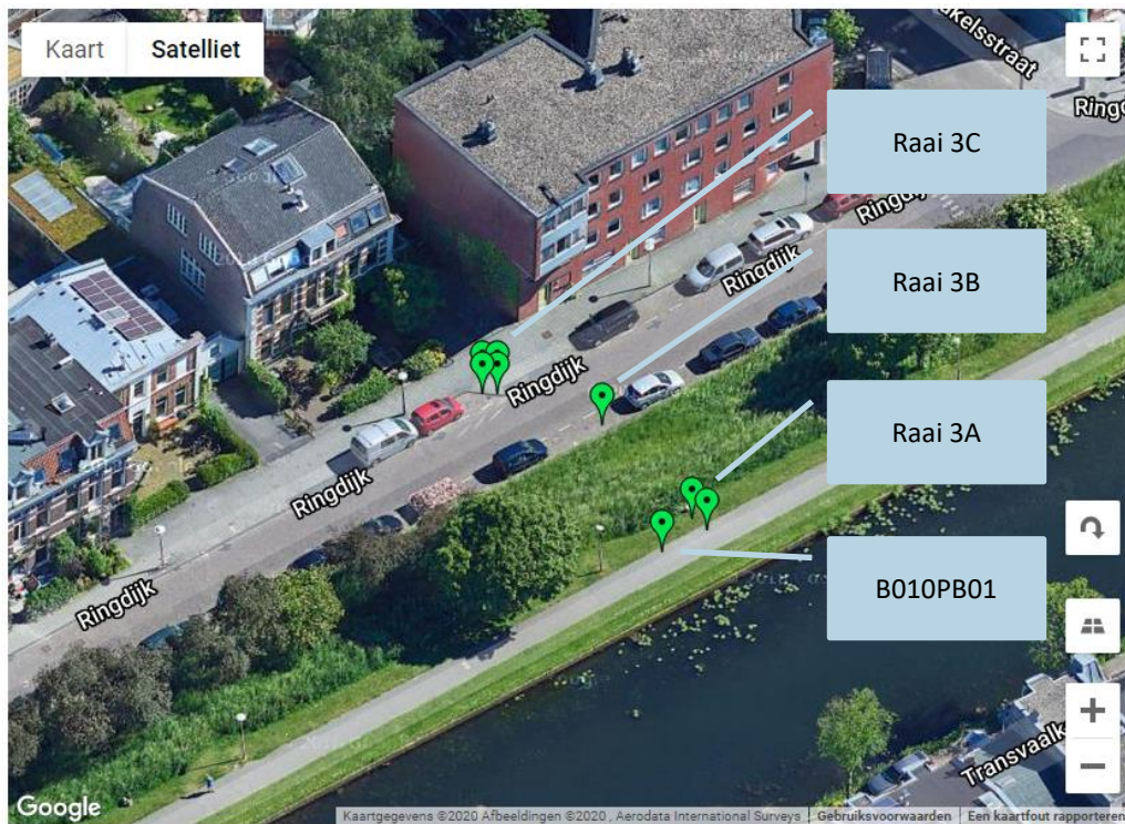
Figuur 3-19: Overzicht locatie peilbuizen en waterspanningsmeters raai 3
