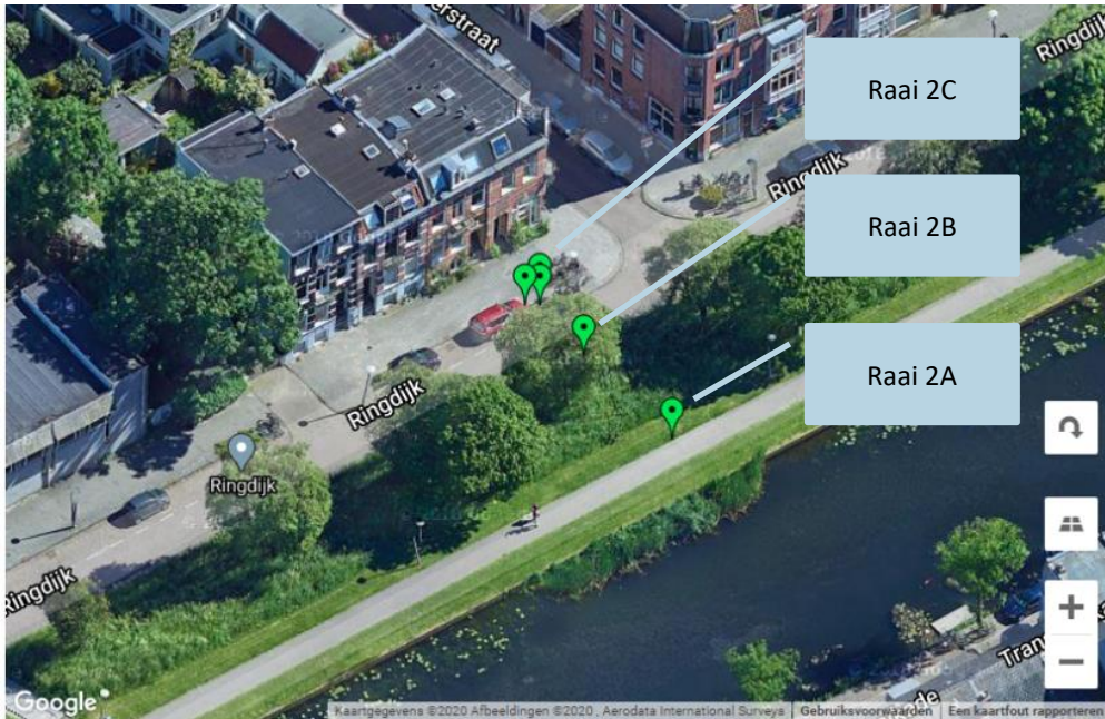
Figuur 3-7: Overzicht locatie peilbuizen en waterspanningsmeters raai 2
