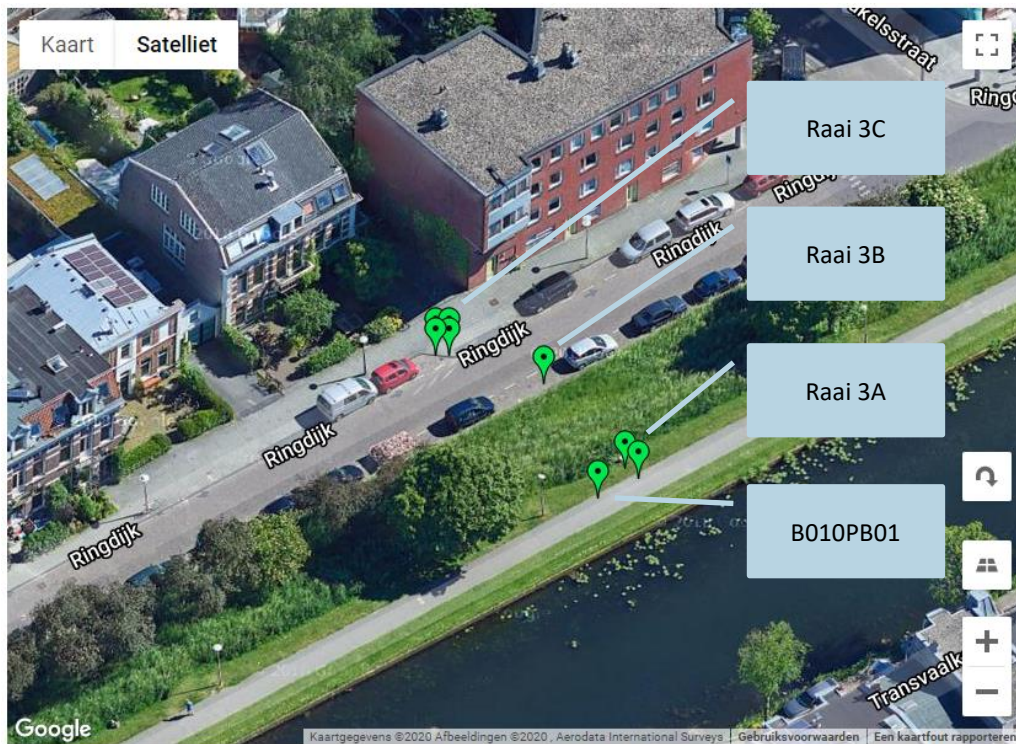
Figuur 3-6: Overzicht locatie peilbuizen en waterspanningsmeters raai 3
