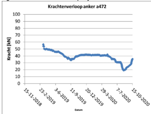
Figuur 6-4: Krachtenverloop bij anker a472 en waterspanningsverloop ter hoogte van raai 1
