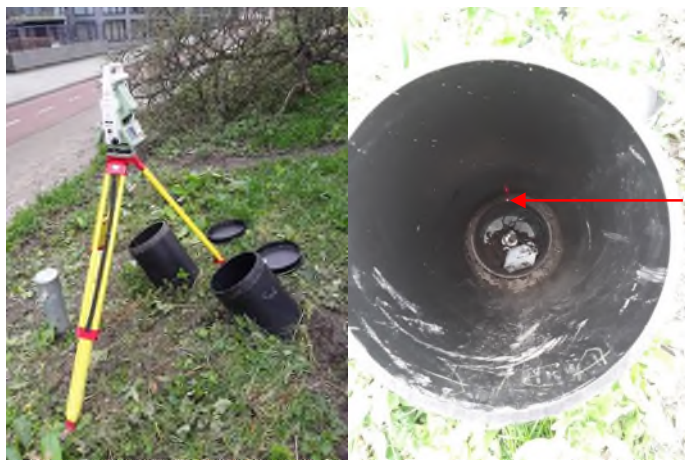
Figuur 2-1 Foto's meetopstelling (links) en de locatie van het meetpunt, zichtbaar door het rode licht van de laser (rechts)
