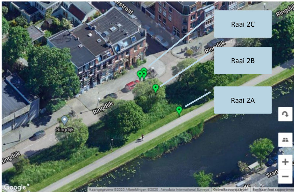
Figuur 3-2: Overzicht locatie peilbuizen en waterspanningsmeters raai 2
