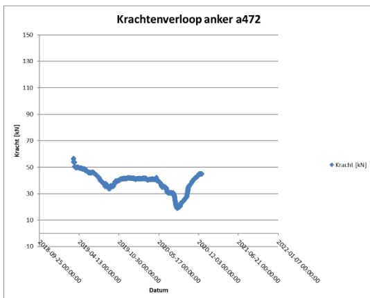
Figuur 5-2: Krachtenverloop bij anker a472 en waterspanningsverloop ter hoogte van raai 1
