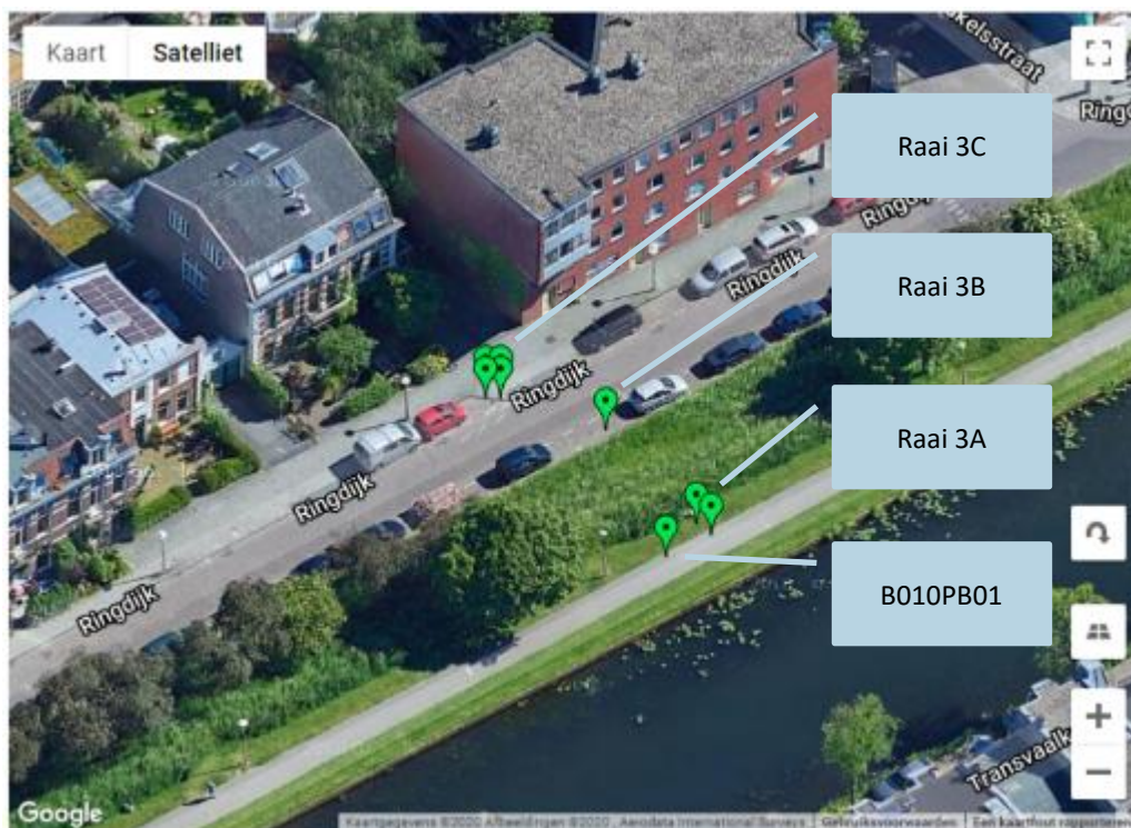
Figuur 3-3: Overzicht locatie peilbuizen en waterspanningsmeters raai 3
