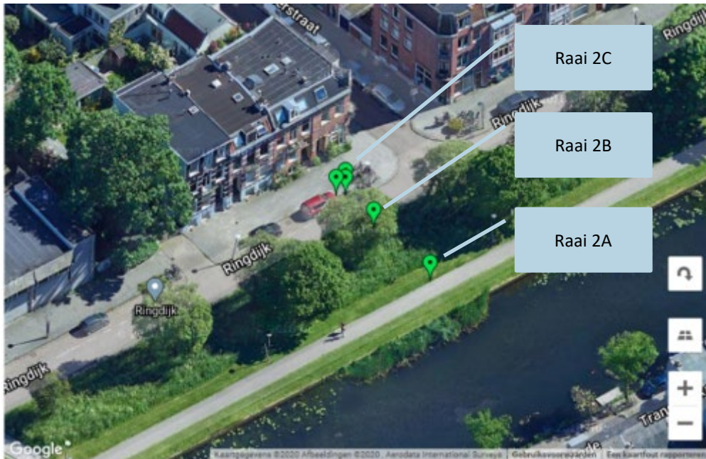
Figuur 3-2: Overzicht locatie peilbuizen en waterspanningsmeters raai 2
