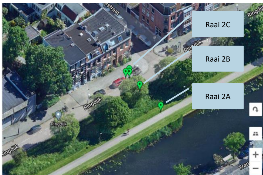
Figuur 4-3 Overzicht locatie peilbuizen en waterspanningsmeters raai 2
