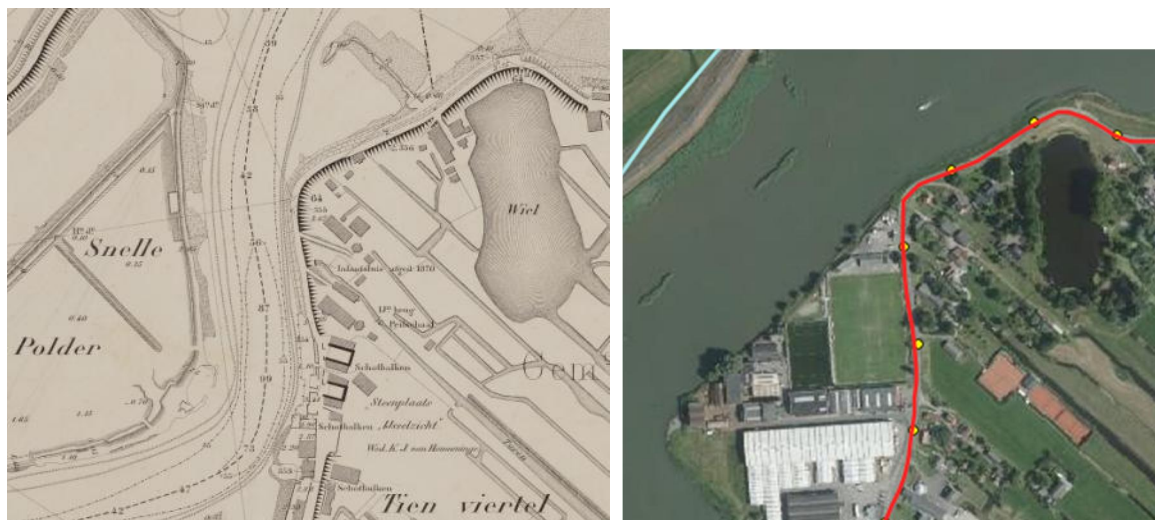
Figuur 6.8 Voorbeeld wijziging IJsselgeul 1907(links geul NAP -10,3 m) – heden (rechts, geul aangevuld tot hoog voorland c.q. voetbalveld) bij 35.4.
