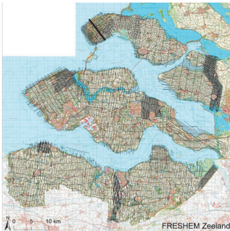
Afbeelding 7: De vlieglijnen waarvoor met behulp van Airborne-EM data over de zoet-zoutverdeling van de ondergrond is verzameld. Onderlinge afstand van de vlieglijnen varieert van 300 tot 100 m voor de interessegebieden. Op een vlieglijn is voor iedere 4 m een meting verricht.
