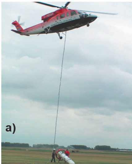
Afbeelding 6: (a) Het Helicopter ElectroMagnetic (HEM)-systeem van BGR (Bundesanstalt für Geowissenschaften und Rohstoffe), gebruikt voor de kartering van de zoetzoutverdeling in de ondergrond van Zeeland; (b) vergelijking van vier zoutprofielen gemeten door elektrische sonderingen (ECPT) met die gemeten door HEM, tijdens een pilot op Schouwen-Duiveland (De Louw e.a., 2011b).
