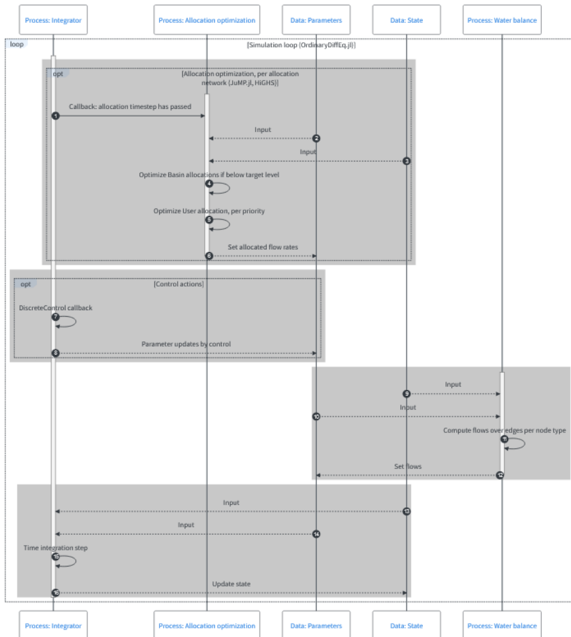
Figuur 2 Rekenproces weergave (sequence diagram) van allocatie, sturing en fysieke simulatie
