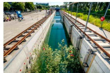
Onderzoek naar de kracht van wijlen in de Deltaport van Deltara, 29 juni 2018. Delft. Foto: Marco De Sijnt
