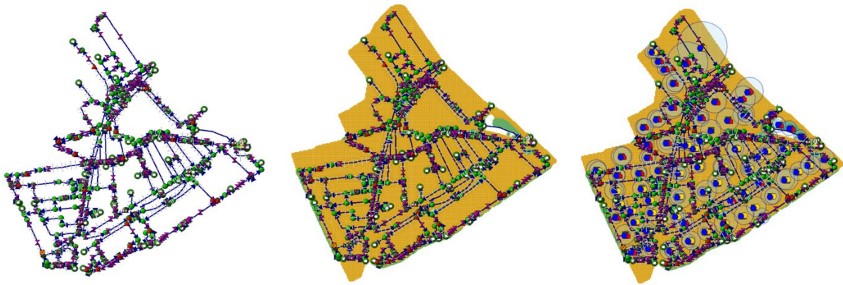
Figuur 1 - Visualisatie van de schematisaties in de D-HYDRO GUI: van 1D schematisatie, naar een 2D model en tot slot de toevoeging van de RR modellering.
