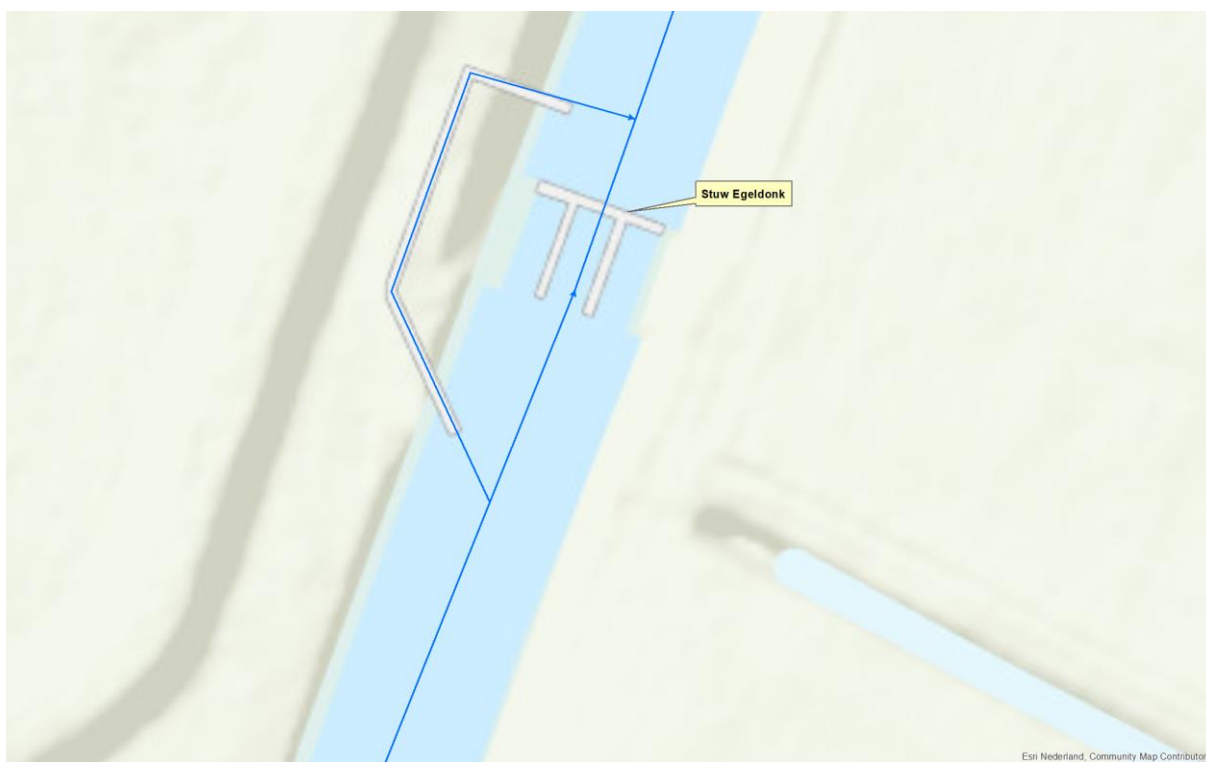
Figuur 4-3 Y-splitsing van de watergang in een tak die door de vispassage gaat (links) en een tak die over de stuw (Stuw Egeldonk) gaat.
