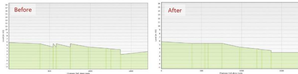
Figuur 3-3: voorbeeld aanpassing van bodemhoogtes door de functie 'spatial check'.
