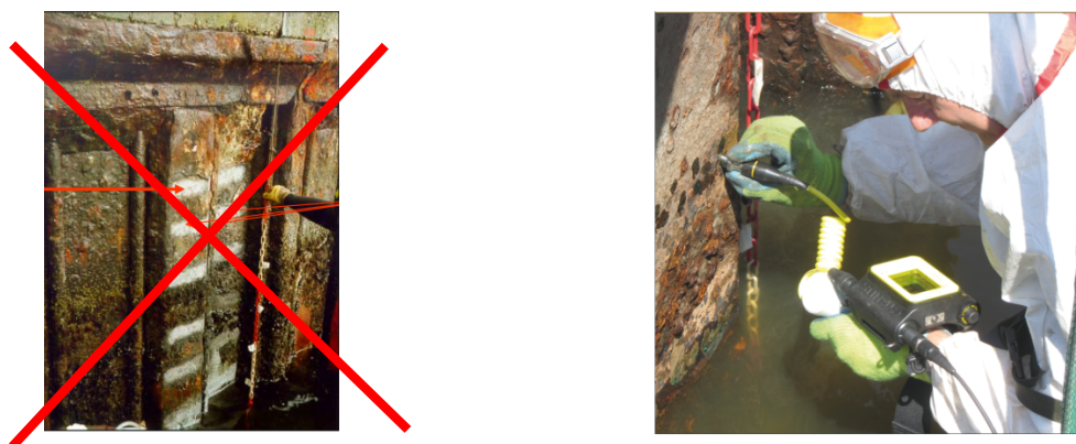
Figuur S1.4 Links: Fout gereinigd oppervlak. Rechts: Juiste lokale reiniging voor plaatsing taster, BAW 2017 [1]
