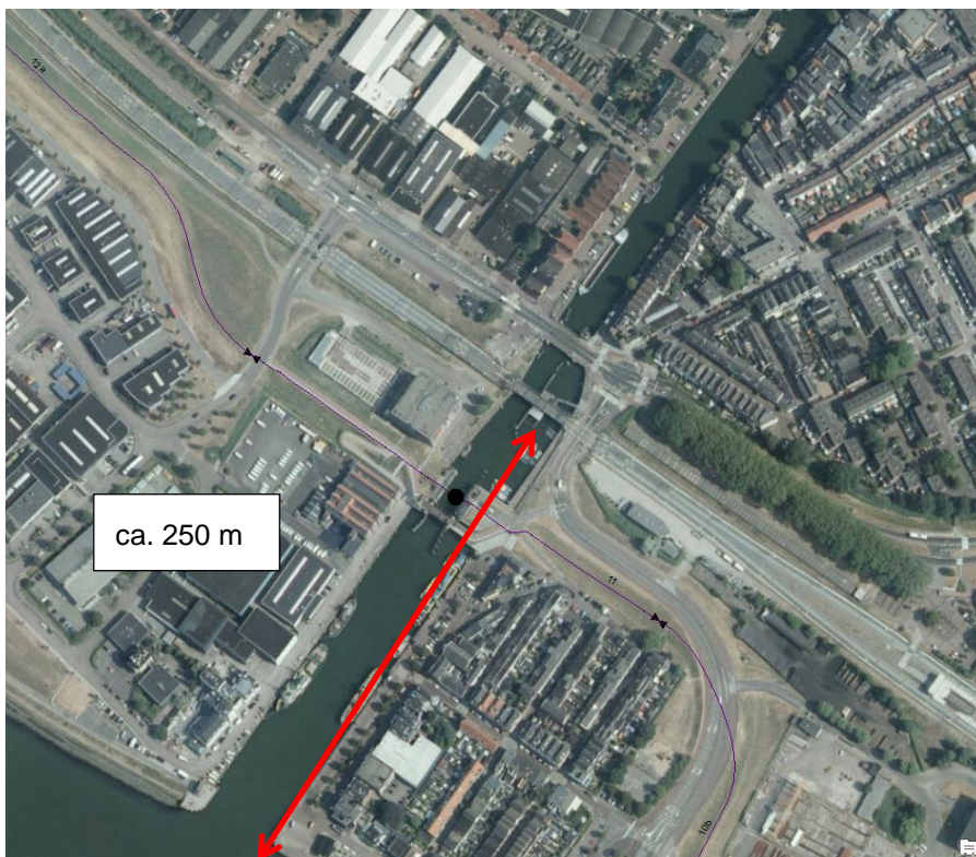
Figuur 3-17: Minimaal aanwezige kwelweglengte voor achterloopsheid
