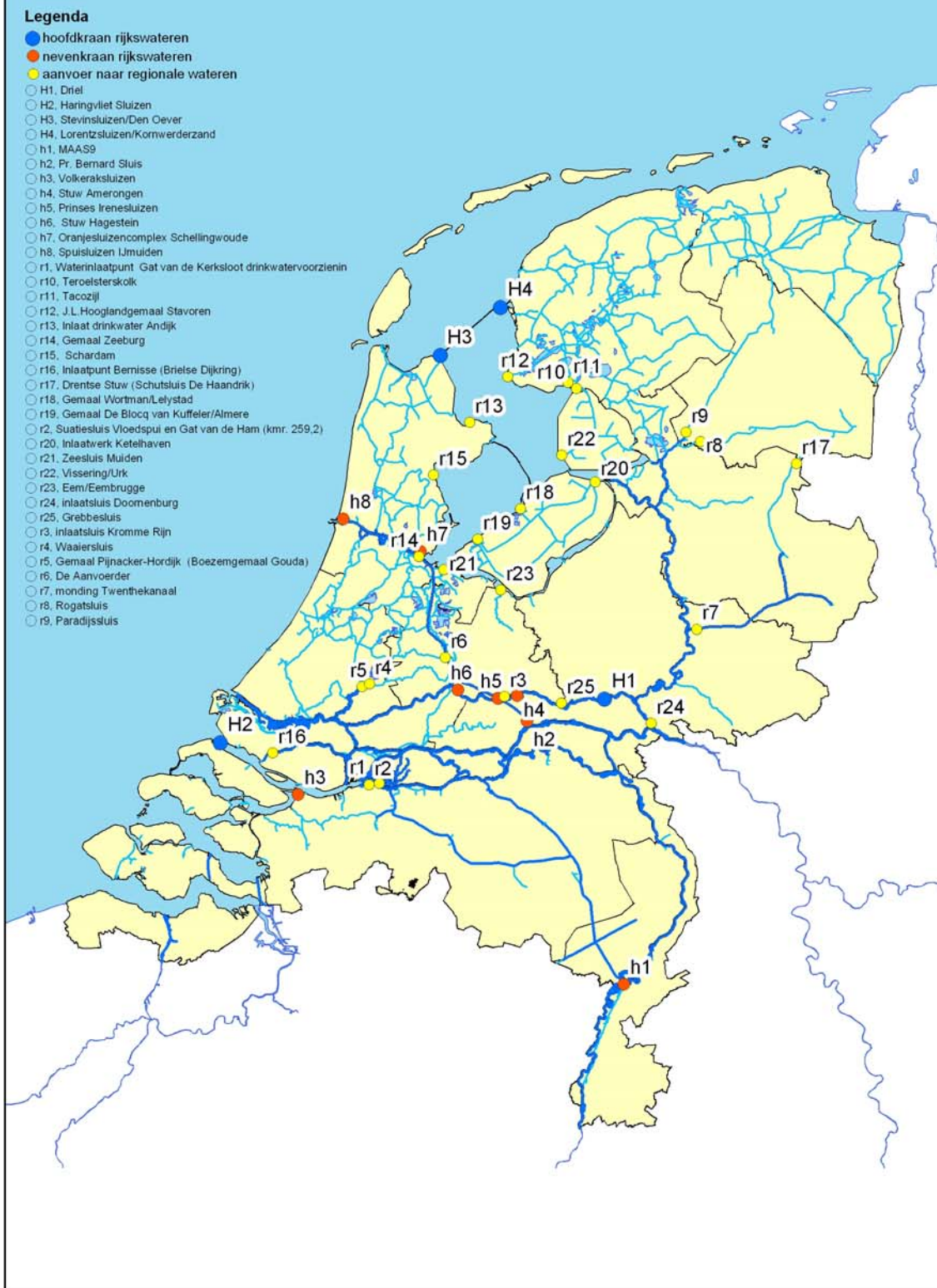
Figuur 2-10: De kranen voor waterverdeling in Nederland.
