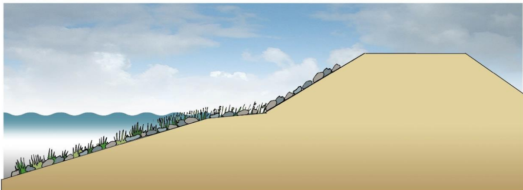
Figuur 10 Rijke Dijk door verbeteren structuur in dijktalud en -teen
