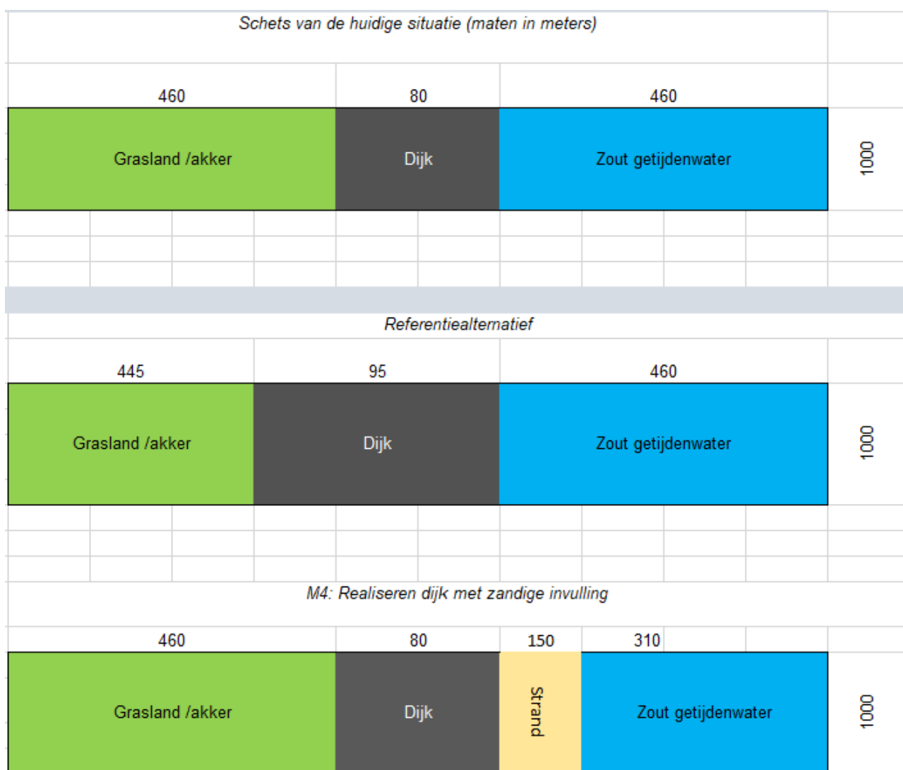
Figuur 11: Schets van de indeling van de natuurtypen van de dijk in de huidige situatie, het referentiealternatief en in geval van maatregel 4; "Realiseren dijk met zandige invulling", getallen zijn de afstanden in meters. De schets is niet op maat.
