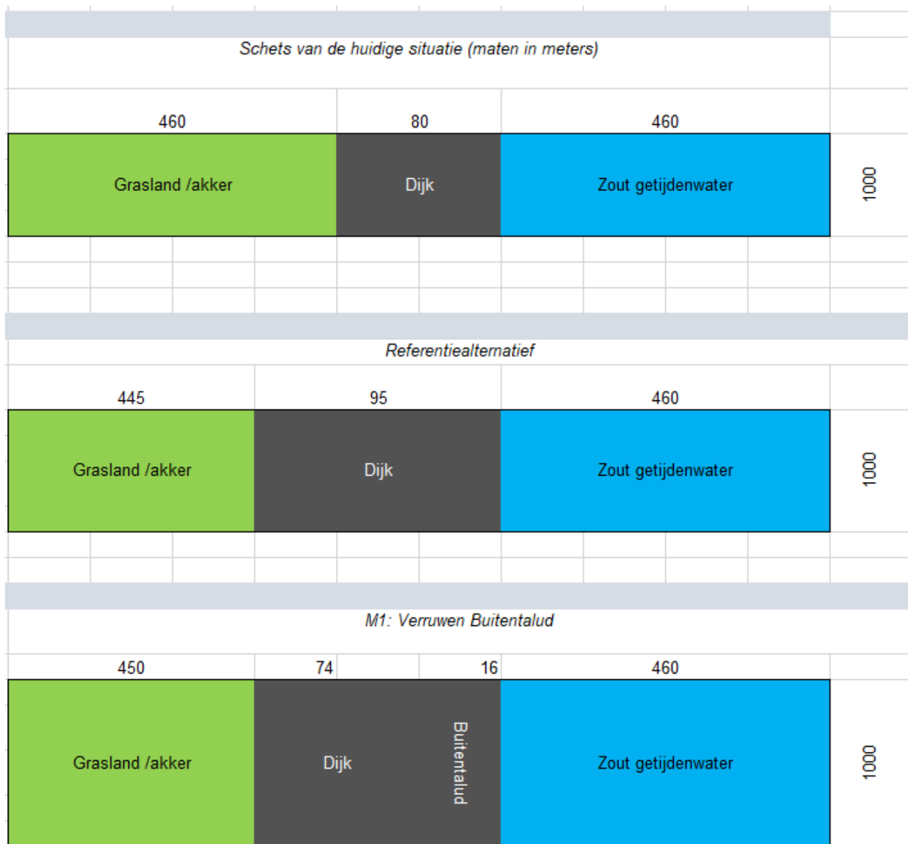
Figuur 8: Schets van de indeling van de natuurtypen van de dijk in de huidige situatie, het referentiealternatief en in geval van maatregel 1; "Verruwen Buitentalud", getallen zijn de afstanden in meters. De schets is niet op maat. Bij de maatregel Verruwen buitentalud bestaat zout getijdenwater voor 25% uit kwelder.
