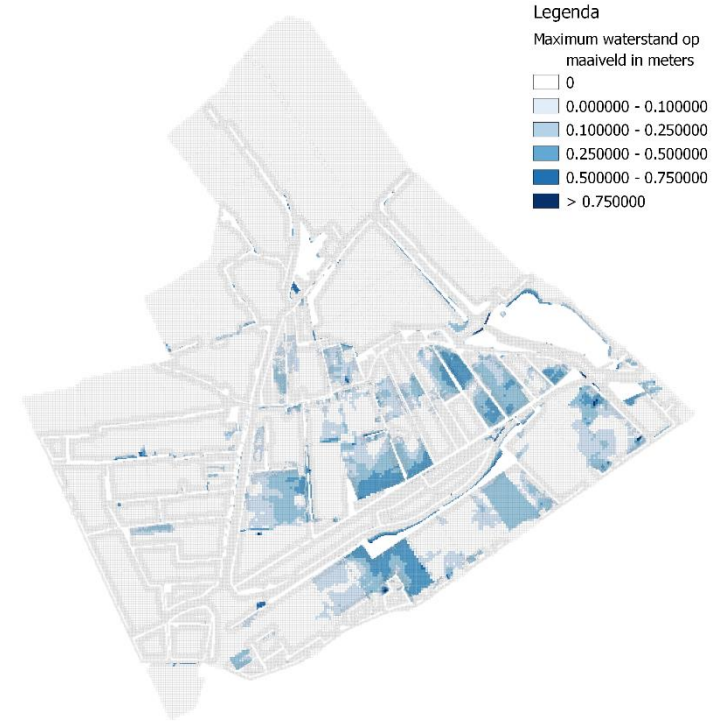
D-HYDRO berekening met SOBEK nabewerking
