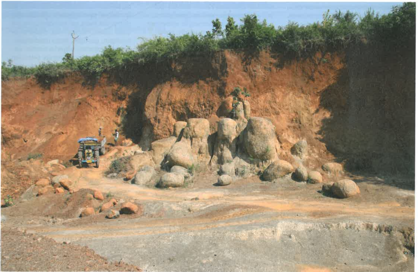
De bodemopbouw in het hardrockgebied. Van boven naar beneden: verweerd gesteente op boulderzone, op gespleten hardrock. De bodem is vaak kleilig verweerd, waardoor bij hevige neerslag interflow door de wortelzone naar lager gelegen gebieden plaatsvindt.
