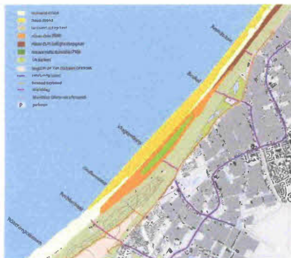
Figuur 1: Ontwerp duincompensatie met een strandbreedte van 200 meter
