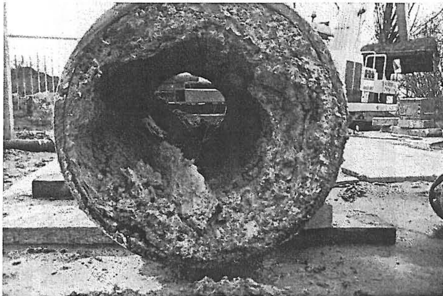
Foto 2: Scaling van \text{Al(OH)}_3 in een \varnothing 600 mm AC buis
