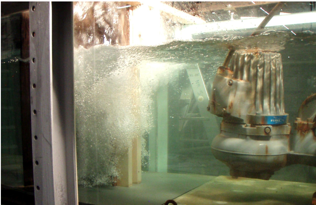
Figuur A.22 Foto van proefopstelling met deflectieschot: 1D breed, 1D vanaf uitstroompunt (Kranendonk (2007))
