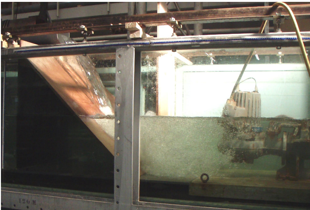
Figuur 4.7 Een vulstuk vergroot de luchtinslag door de pomp (Kranendonk 2007)
